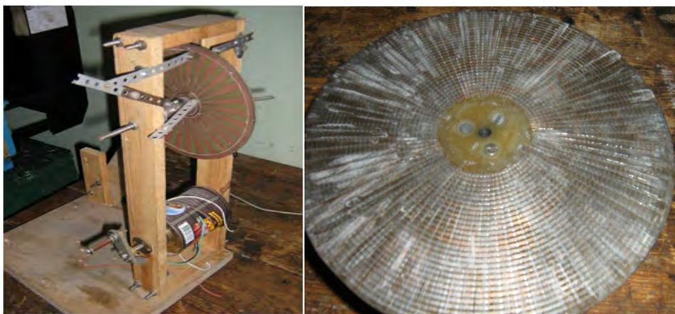
Рис. № 5.2. Практическая реализация электростатического высоковольтного генератора с сверх высокоскоростным наведением электрических зарядов.
