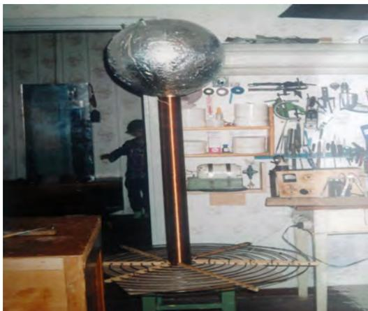
Рис. № 5.2. Высоковольтный трансформатор Тесла.
