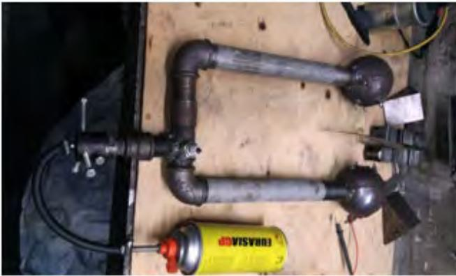
Рис. № 8.4.2. Стенд из двух источников детонационных волн трубчатой формы с встречными сферическими резонаторами на выходе
