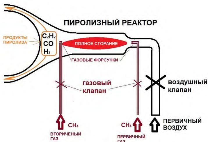
Рис. № 7.16.4. Двух этапный окислительный пиролиз (не полное сгорание топлива с вводом в продукты не полного сгорания новой порции топлива).
