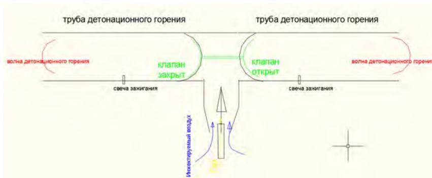
Рис. № 7.11.1. Детонационный двухтрубный источник энергии с механическим зависимым управлением.
