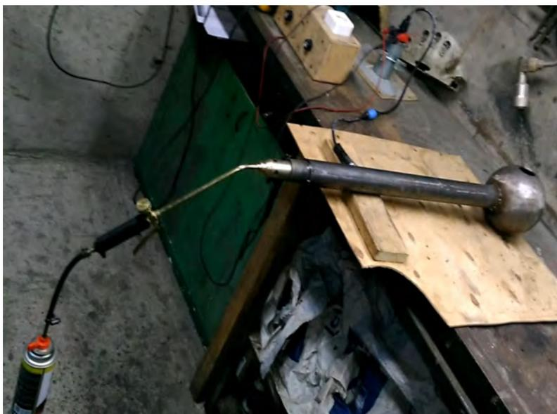
Рис. № 8.9.6. Прототип генератора со сферическим резонатором диаметром 0,15 м.
