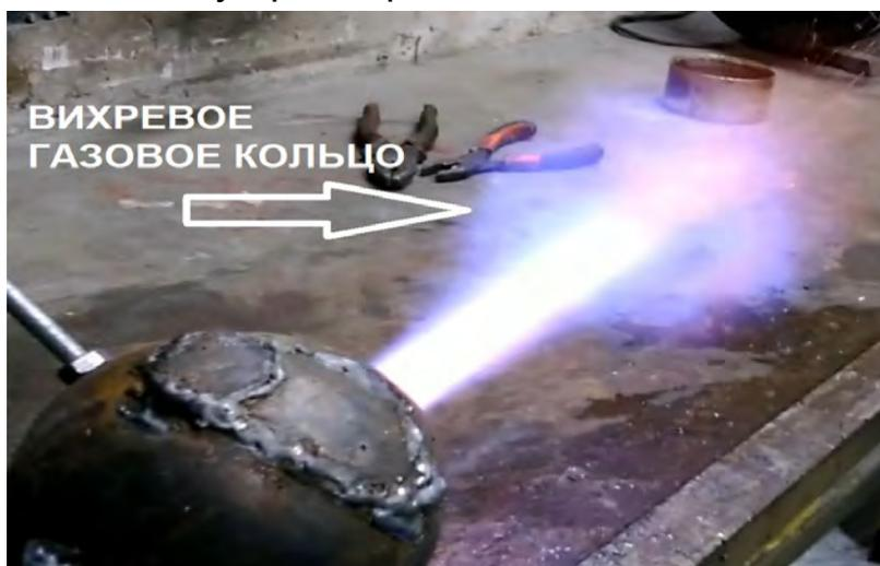
Рис. № 8.9.7. Вихревое газовое кольцо на выходе сферического резонатора.
