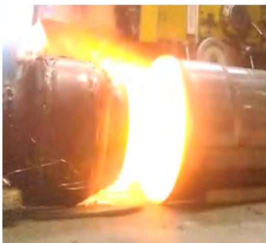
Рис. № 8.2.5. Распространение волны детонационного горения в патрубке сбора продуктов горения.
