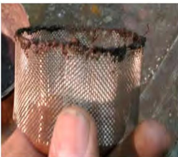
Рис. № 8.2.3. Сетка ввода оксида железа в волну детонационного горения.
