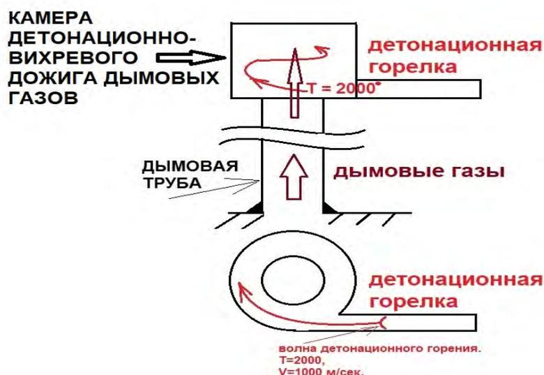
Рис. № 8.5.1. Центростремителное вихревое сжатие волны детонационного горения для технологических целей (способ получения сверхвысоких температур).
