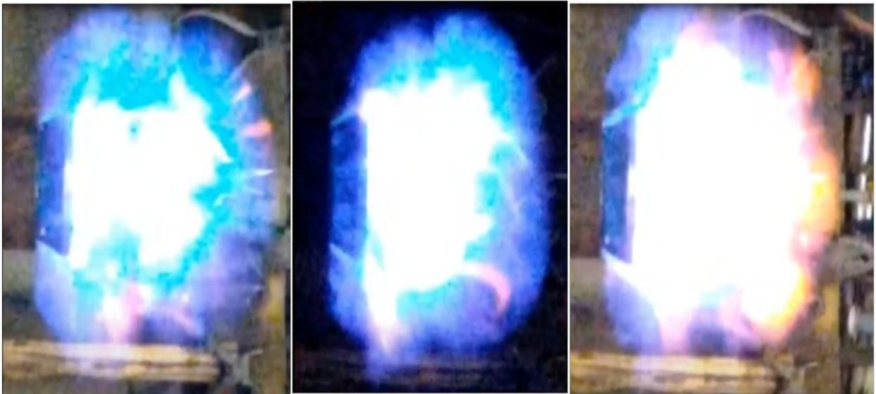
Рис. № 8.13.5. Визуализация и цвет (температура) двух потоков детонационно-вихревого горения на выходе из прямоточной трубки Ранка-Хилша.
