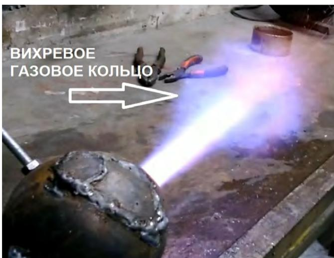
Рис. № 8.23.6. Вихревое газовое кольцо на выходе сферического резонатора.
