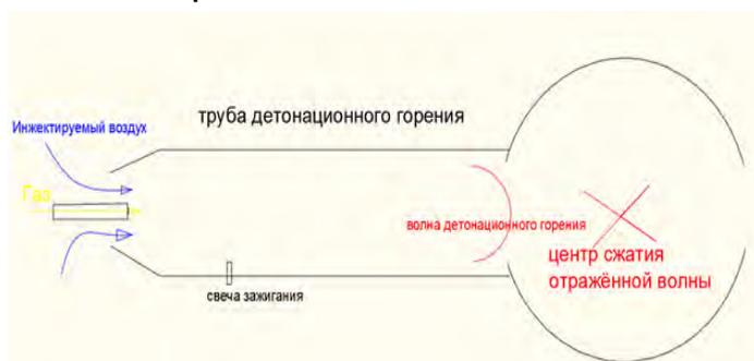
Рис. № 7.3.1. Детонационный источник энергии цилиндрической формы, бесклапанный, с сферическим резонатором на выходе.
