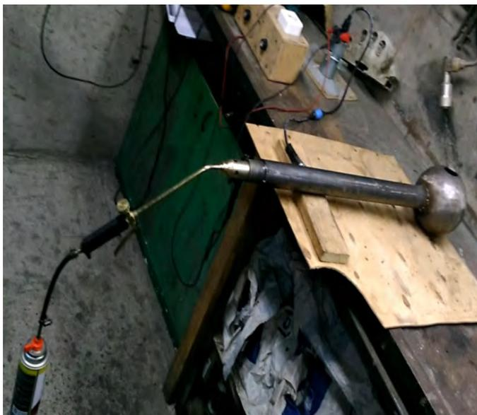
Рис. № 8.23.5. Прототип генератора со сферическим резонатором диаметром 0,15 м.
