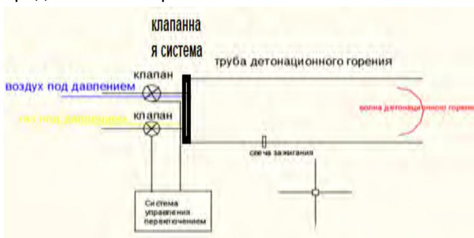
Рис. № 6.8.3. Вариант установки много клапанной системы в торцевую часть трубчатого детонационного источника энергии.
