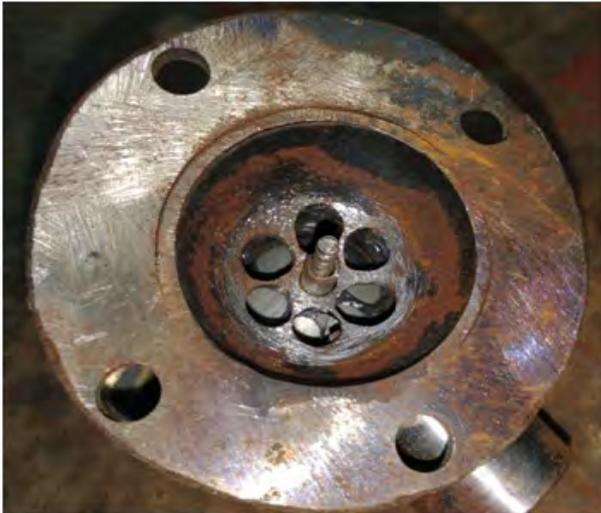
Рис. № 8.21.2. Конструктивное исполнение одного полу шарового клапана
