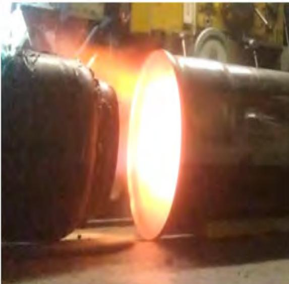
Рис. № 8.3.3. Распространение волны детонационного горения в патрубке сбора продуктов горения.
