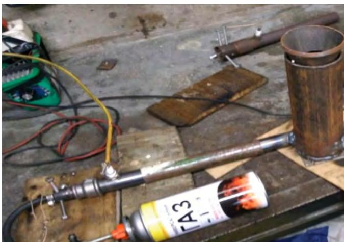
Рис. № 8.13.4. Конструктивное исполнение вихревой трубы для экспериментов по детонационному горению.
