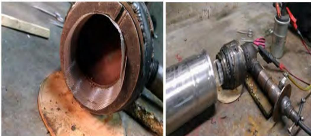
Рис. № 8.2.4. Установка сетки ввода оксида железа в волну детонационного горения детонационной горелки.
