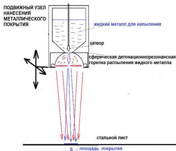
Рис. № 8.19.1. Квазиимпульсная технология напыления защитных металлических покрытий.
