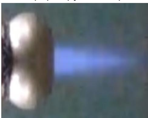
Рис. № 8.24.3. Сходящийся клин волны детонационного горения, по оси которого формируется пара вихревых колец.
