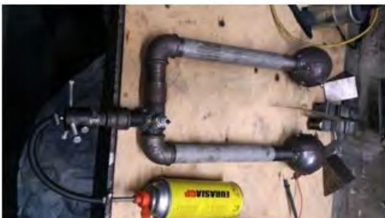
Рис. № 1. Стенд исследования детонационного схлопывания двух волн.
