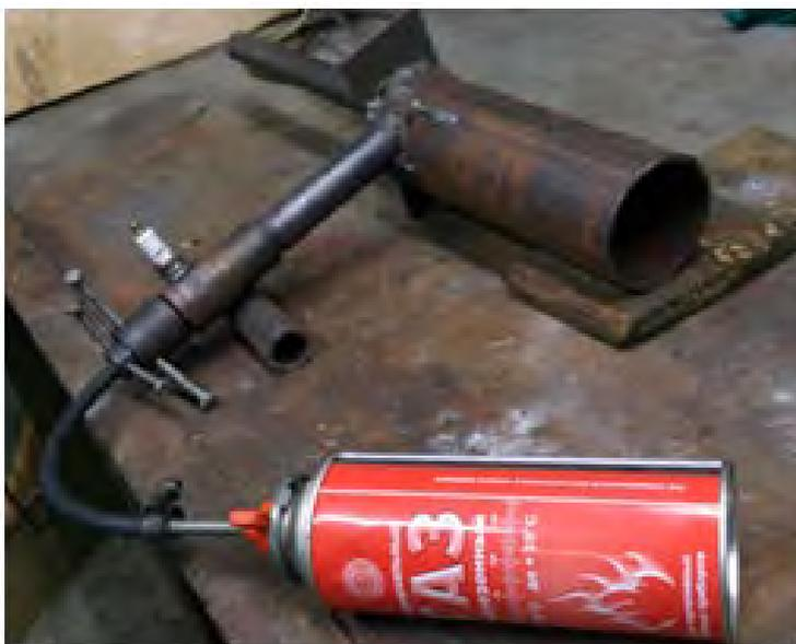
Рис. № 8.5.2. Испытательный стенд в виде трубчатого источника волн детонационного горения, тангенциально соединённого с цилиндром, в котором будет распространяться тангенциально волна детонационного горения.
