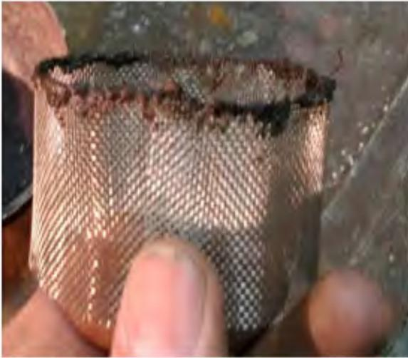
Рис. № 8.3.2. Сетка ввода оксида железа в волну детонационного горения.
