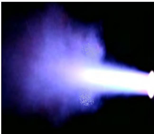
Рис. № 8.23.4. Вихревое газовое кольцо на выходе сферического резонатора.
