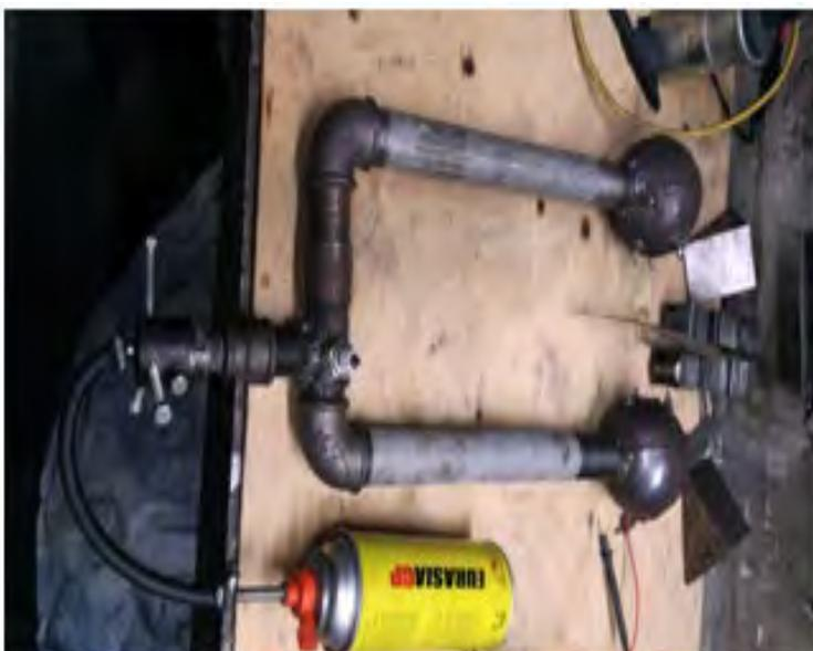
Рис. № 8.25.1. Испытательный стенд из двух источников волн детонационного горения.
