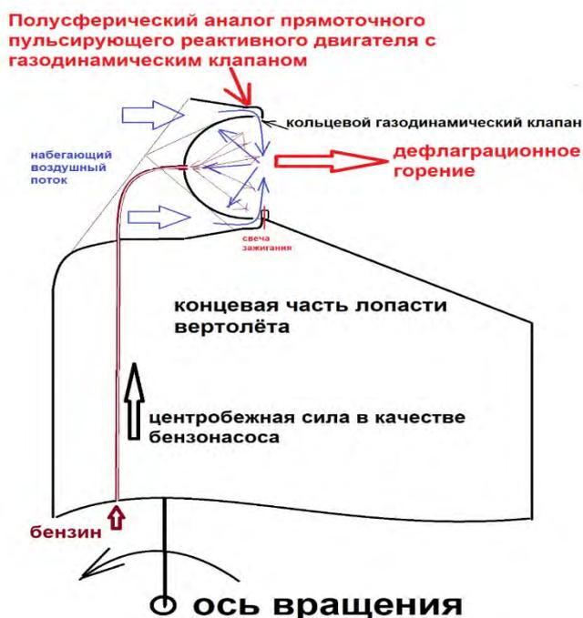
Рис. № 5.1. Полусферический реактивный двигатель, предложен Поповым Николаем Ивановичем.
