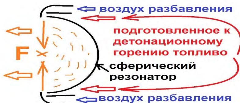
Рис. № 7.16.1. Упрощённый вид детонационно-резонансной горелки.
