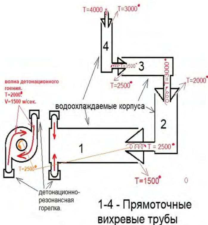
Рис. № 7.15.2. Многоступенчатый способ получения сверх высоких температур.
