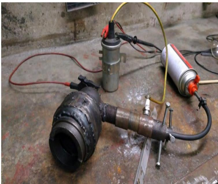
Рис. № 6.2.2. Внешний вид детонационного источника энергии цилиндрической формы с полусферическим резонатором на выходе.
