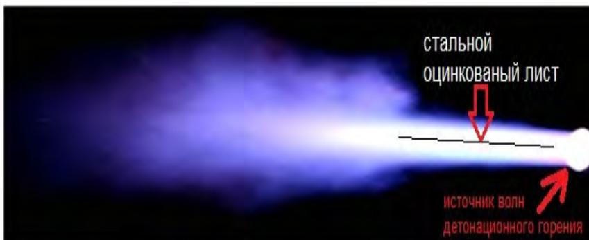
Рис. № 8.18.2. Размещение стального листа в волне детонационного горения.
