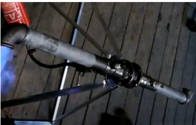
Рис. № 8.21.4. Стенд исследования детонационного привода лопастей вертолѐта
