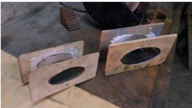
Рис. № 5. Резонаторы в виде эллиптического патрубка.
