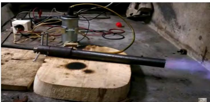
Рис. № 8.13.2. Источник волн детонационного горения.
