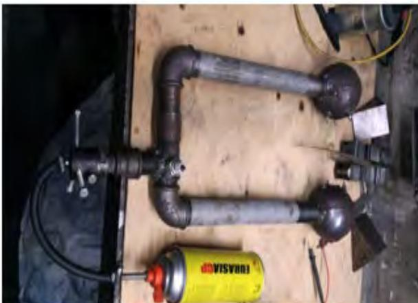
Рис. № 8.11.2. Стенд изучения схлопывания двух волн детонационного горения.
