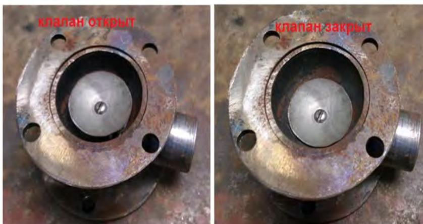
Рис. № 7.11.2. Взаимосвязанные клапаны управления детонационным горением.
