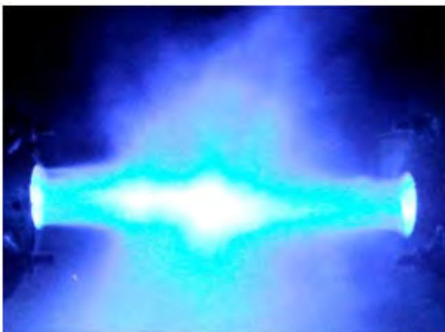
Рис. № 8.11.3. Визуализация встречного схлопывания двух волн детонационного горения на расстоянии между горелками =  $2 \cdot (0,9 \cdot L)$ .
