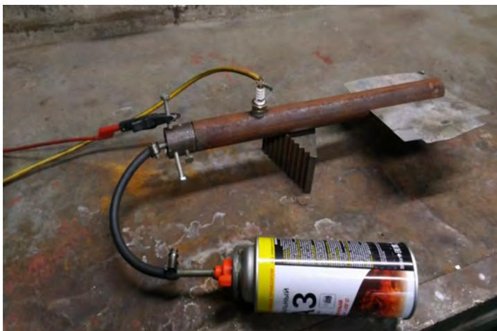
Рис. № 8.18.4. Стенд исследования воздействия волн детонационного горения на цинковое покрытие стального листа.
