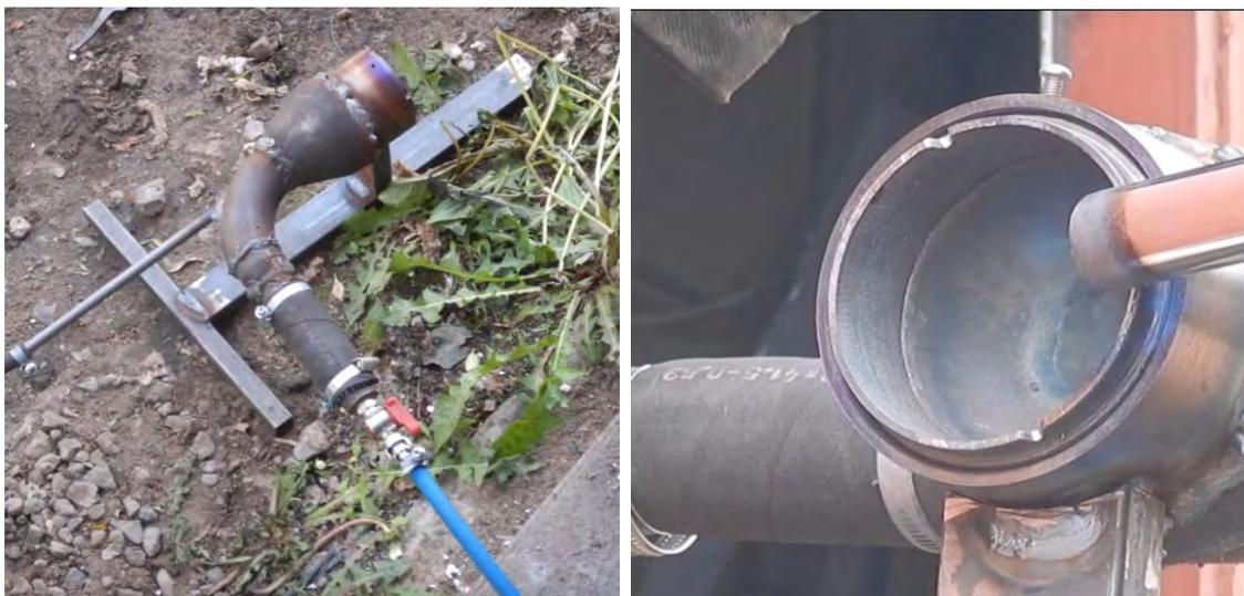
Рис. № 5.3. Внешний вид дефлаграционной полусферической горелки.
