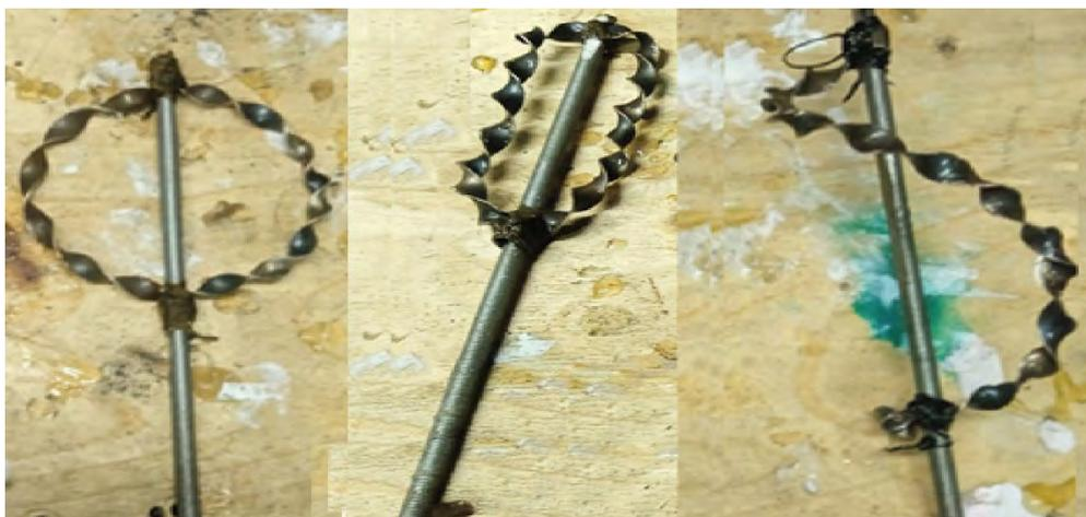
Рис. № 7. Ленточные многомерные кольцевые вертикальные типы завихрителей.
