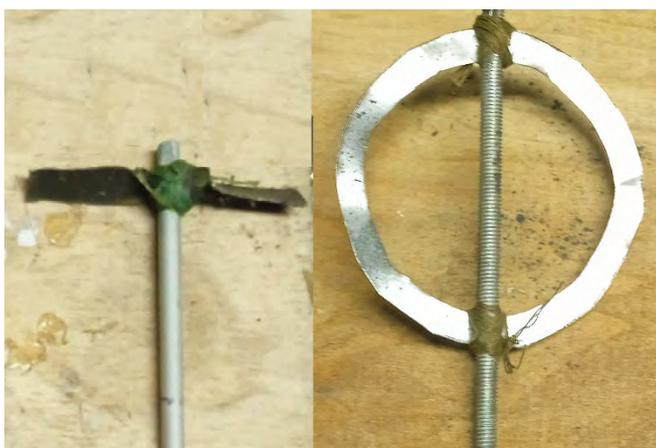
Рис. № 3. Эталонные образцы классической винтовой и лопастной кольцевой мешалки.
