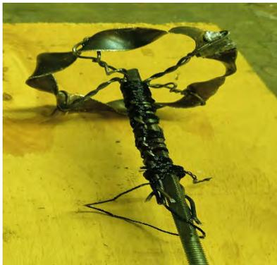
Рис. № 6. Ленточный многомерный кольцевой горизонтальный завихритель.
