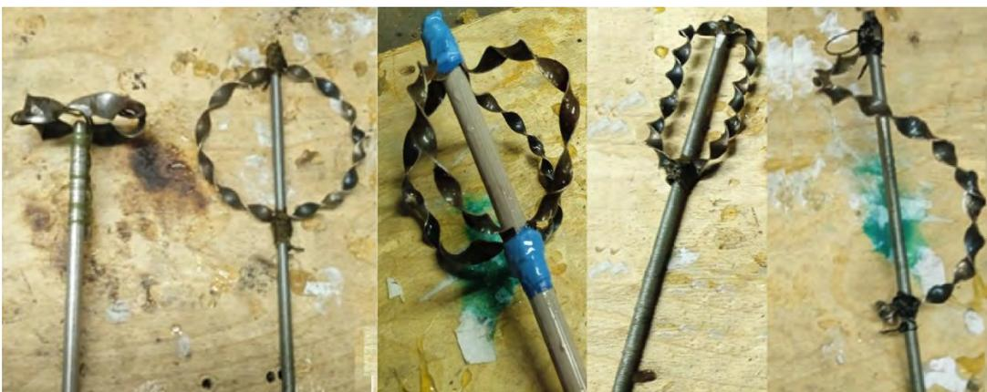
Рис. № 1. Ленточные многомерные завихрители.
