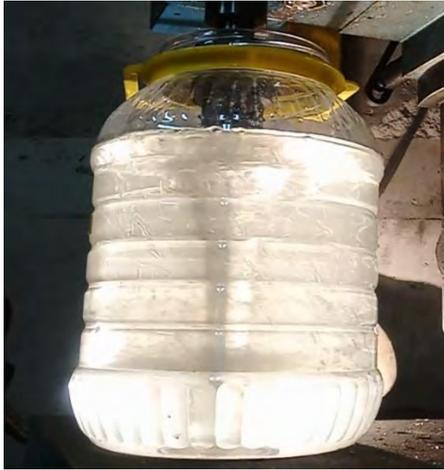
Рис. № 5. Смешивание / перемешивание в одном одномерном торовом вихревом потоке жидкости.
