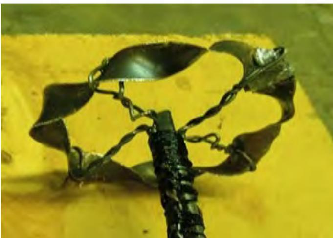
Рис. № 2. Ленточный многомерный кольцевой горизонтальный завихритель.
