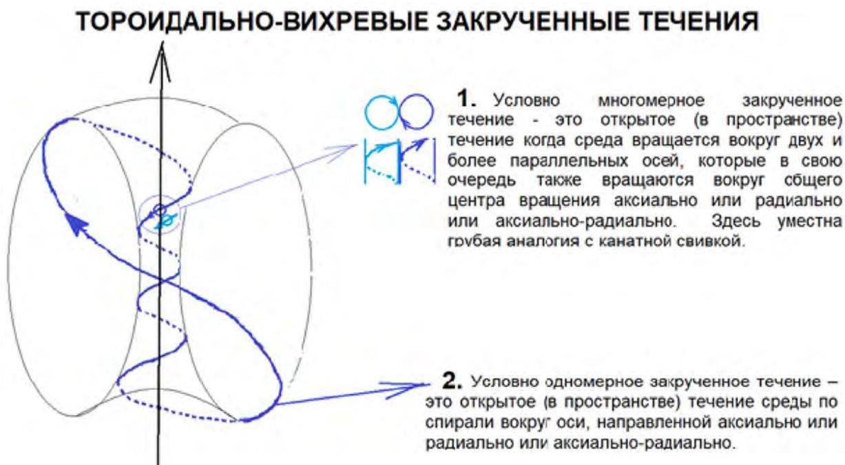
Рис. № 1. Торoidalно-вихревые закрученные течения.
