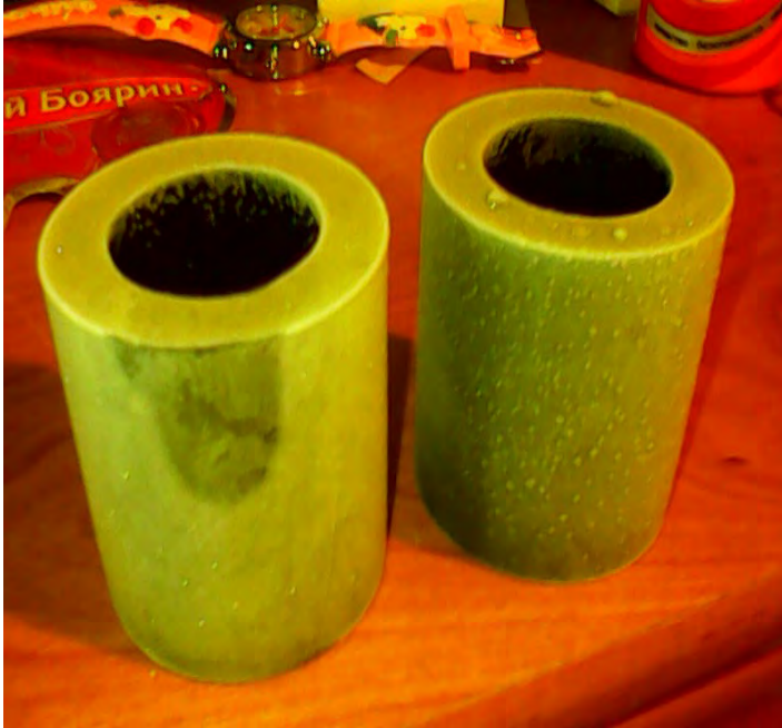
Рис. № 9.4. Готовые втулки после морозильника.
