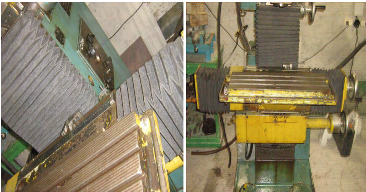
Рис. № 8.6. Защитные гофры в сборе.
