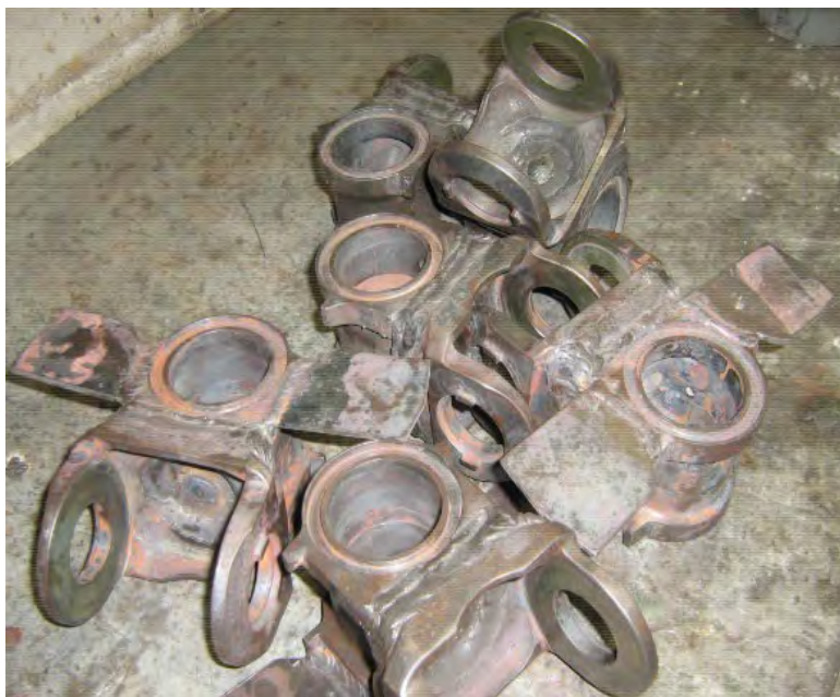
Рис. № 11.6. Готовое изделие, сваренное “на горячую”.
