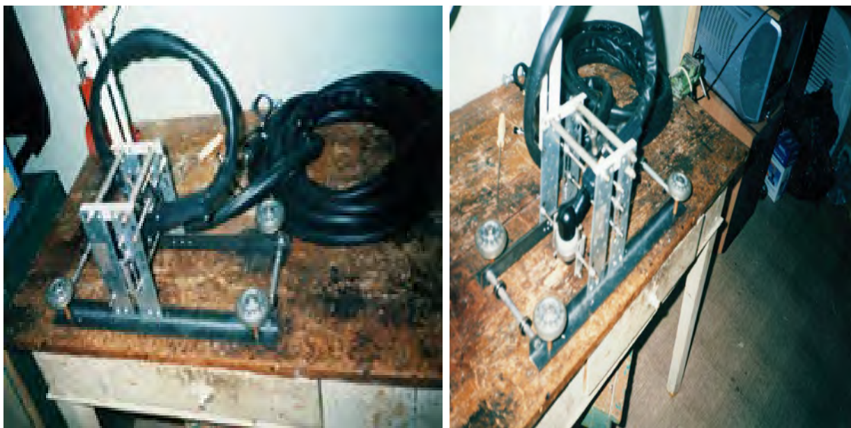
Рис. № 10.1. Механизм автоматической подачи горелки воздушно плазменного резака
