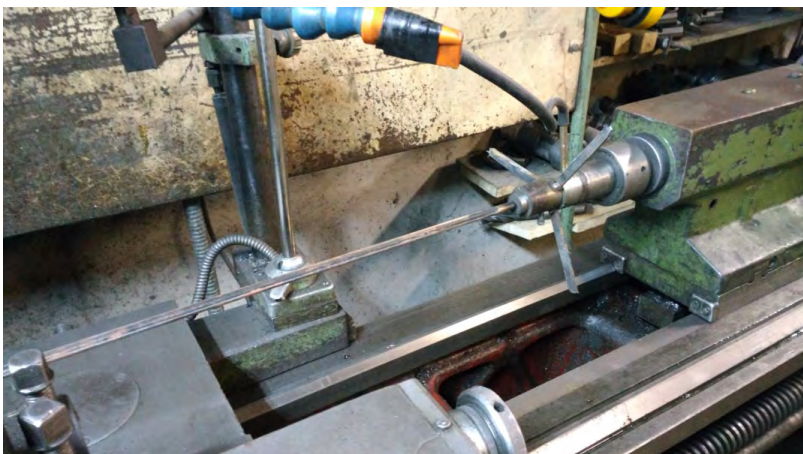
Рис. № 7.2. Цанговый патрон со сверлом на вращающемся конусе.
