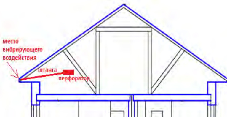
Рис. № 15.1. Схема реализации способа воздействия на сосульки с обратной стороны мест образования.
