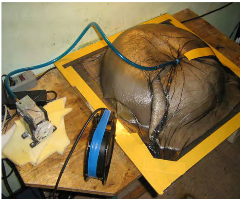
Рис. № 13.2. Схема вакуумной формовки.
