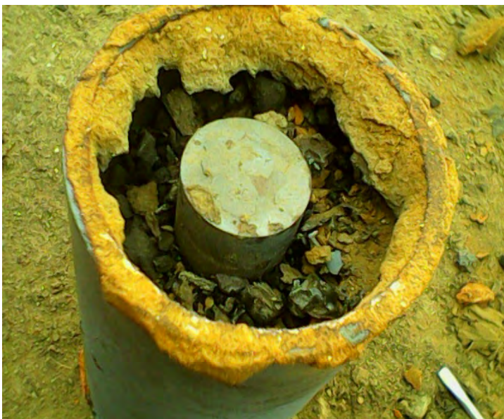
Рис. № 9.1. Отпуск стальной заготовки с одновременным получением карбюризатора.
