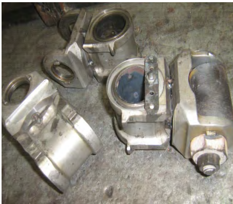
Рис. № 11.3. Сборка на прихватках.
