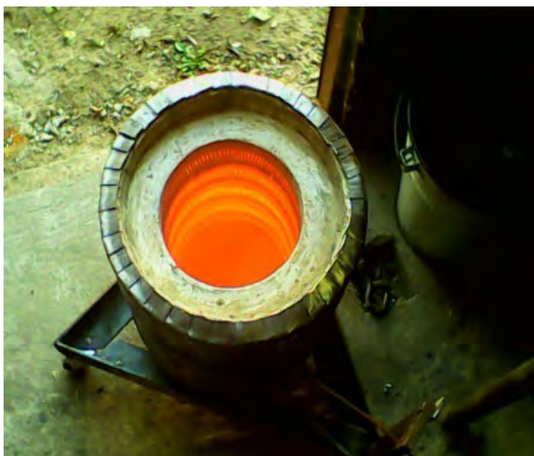
Рис. № 11.4. Электрическая печь сопротивления для разогрева сборки.
