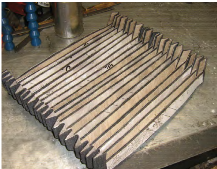
Рис. № 8.4. Формовка гофра
