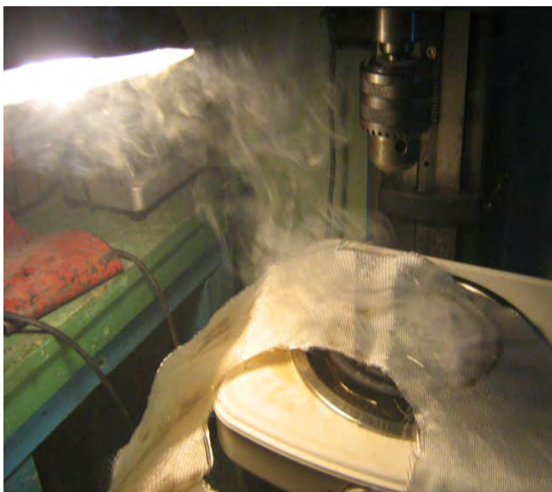
Рис. № 13.1. Обжиг стеклоткани, удаление парафина.
