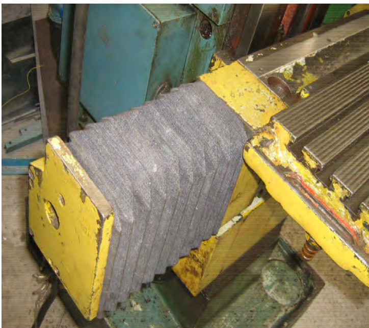
Рис. № 8.1. Защитная гофра направляющей фрезерного станка
