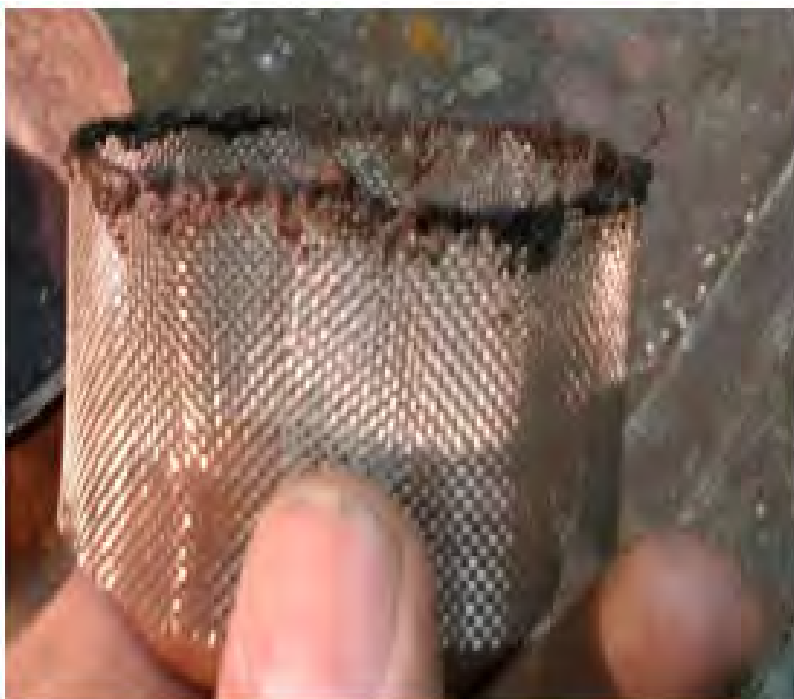
Рис. № 6.3. Сетка ввода оксида железа в волну детонационного горения.
