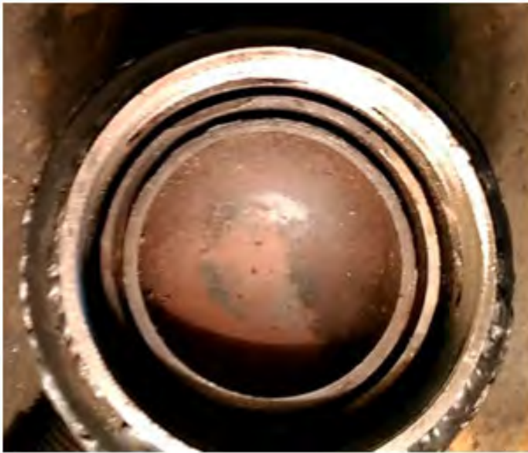
Рис. № 6.2. Диаметральные каналы ввода химического соединения и волны детонационного горения.
