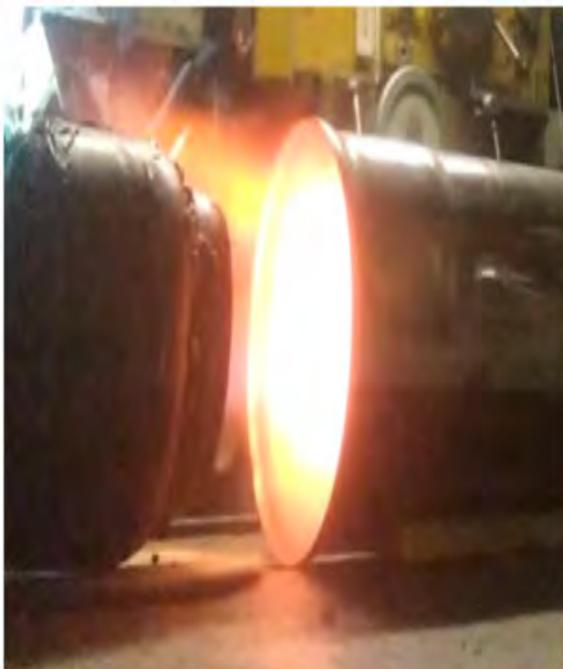
Рис. № 9.3. Распространение волны детонационного горения в патрубках сбора продуктов горения.
