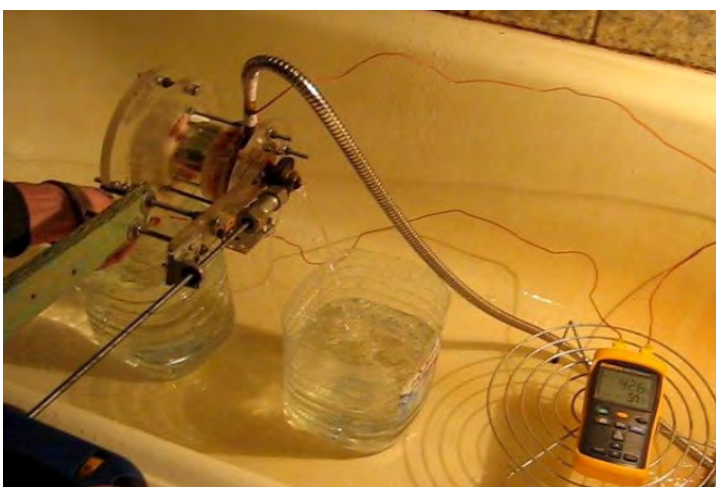
Рис. № 13.4. Эксперимент по фильтрации водопроводной воды
