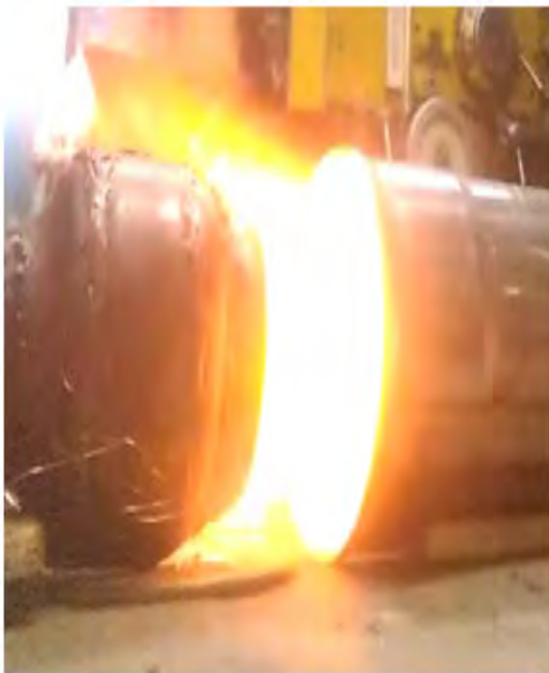
Рис. № 6.5. Распространение волны детонационного горения в патрубке сбора продуктов горения.
