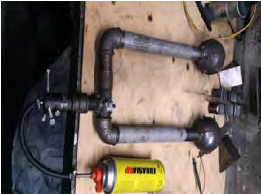
Рис. 8.2. Стенд из двух источников детонационных волн по типу трубчатой формы с сферическим резонатором и непосредственной инжекцией воздуха газом (пропаном).
