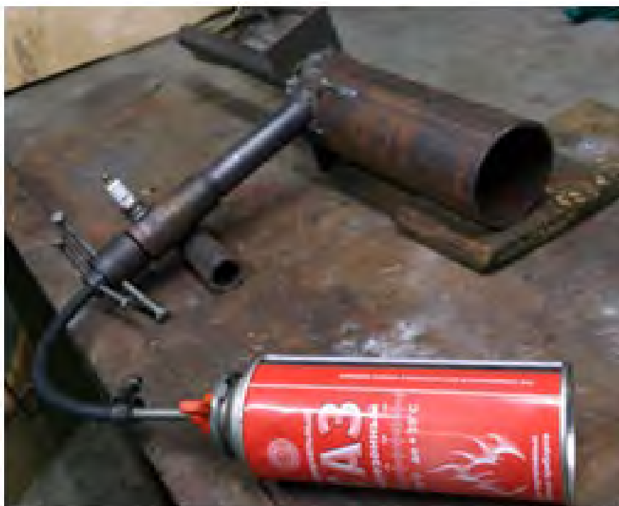
Рис. № 9.2. Стенд изменению направления волны детонационного горения.
