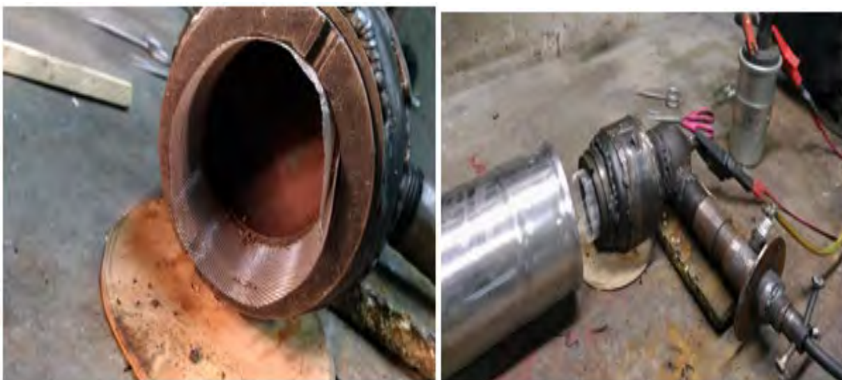
Рис. № 6.4. Установка сетки ввода оксида железа в волну детонационного горения детонационной горелки.
