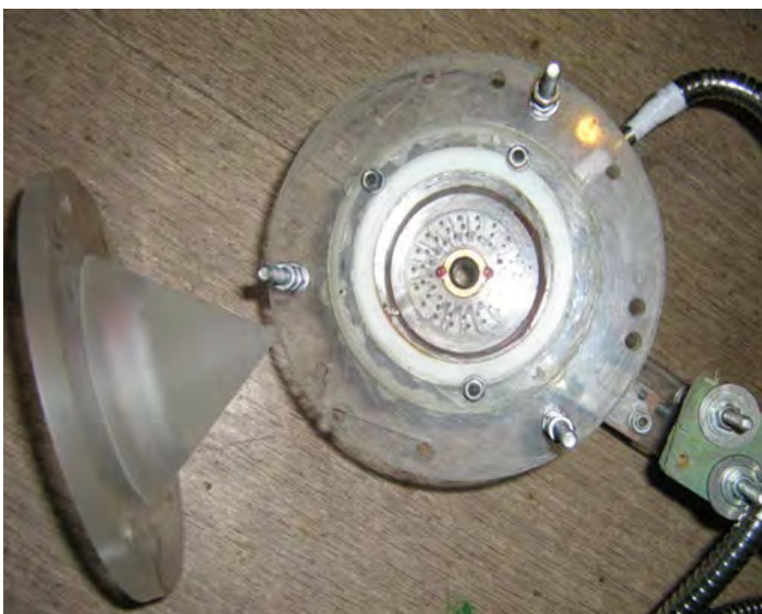
Рис. № 13.3. Общий вид неподвижного завихрителя с размещёнными по спирали полно проходными отверстиями, в которых установлены индивидуальные завихрители.
