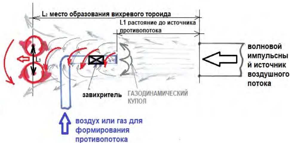
Рис. № 15.4. Способ формирования обратного ротационного вихревого тороида.
