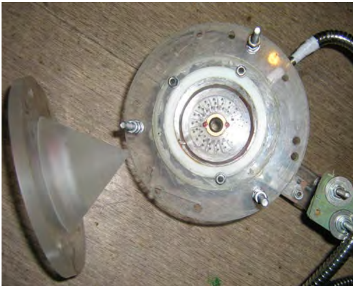
Рис. № 10.4.3. Общий вид неподвижного завихрителя с размещёнными по спирали полно проходными отверстиями, в которых установлены индивидуальные завихрители.
