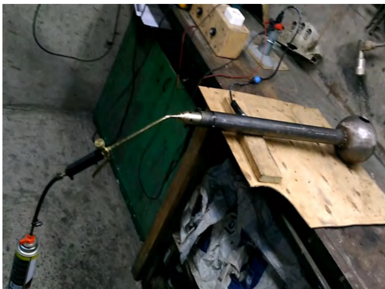
Рис. № 10.27.6. Прототип генератора со сферическим резонатором диаметром 0,15 м.
