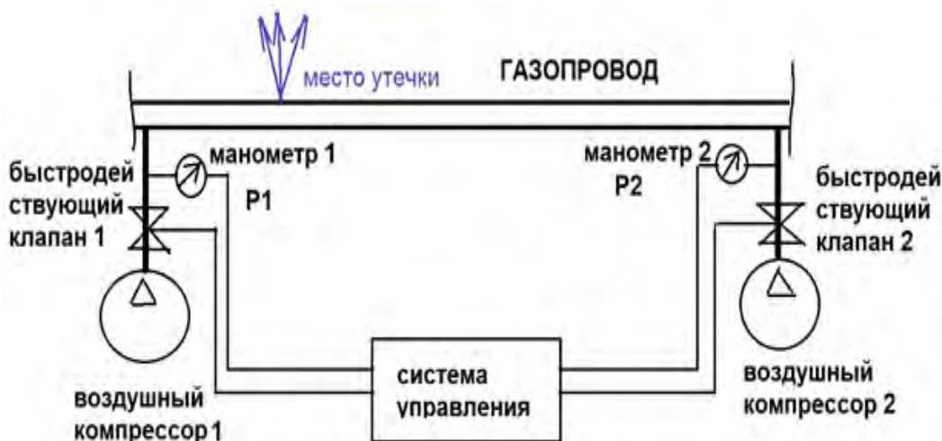
Рис. № 15.1. Схема реализации способа диагностики газопроводов способом формирования ударных волн
