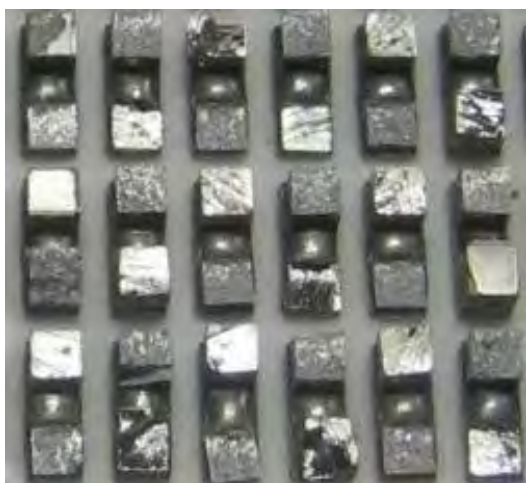
Рис. № 2. Элемент Пельтье в разобранном виде.
