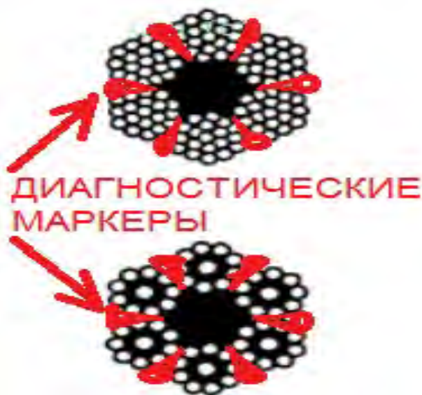
Рис. № 19.1. Конструктивное исполнение само диагностируемого стального каната.
