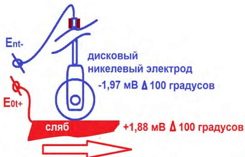
Рис. № 7.3. Измерительный дисковый термоэлектрод системы диагностирования внутренних дефектов слябов в МНЛЗ с помощью множества дисковых термоэлектродов.
