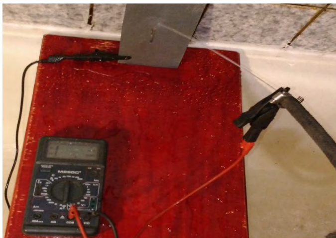
Рис. № 24.2. Измерение сопротивления струи технической воды на постоянном токе.
