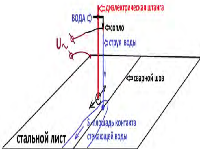
Рис. № 24.4. Схема реализации гидрорезистивного способа контроля герметичности листовых сварных соединений .
