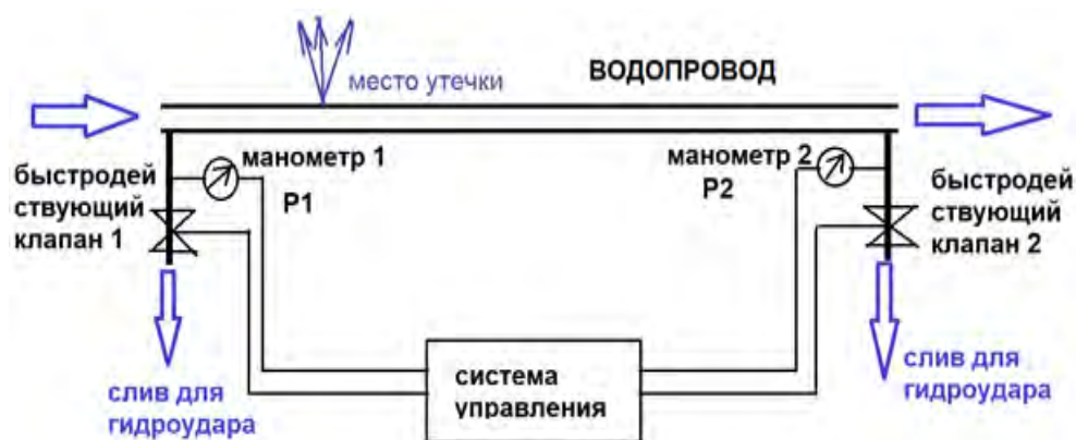
Рис. № 16.1. Схема реализации способа диагностики водопроводов способом формирования ударных волн. (гидравлический удар как основа диагностики)
