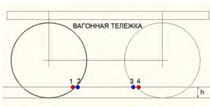
Рис. № 1.2. Способ идентификации по колёсной базе.
