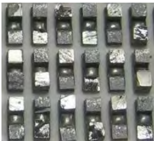
Рис. № 2. Элемент Пельтье в разобранном виде.
