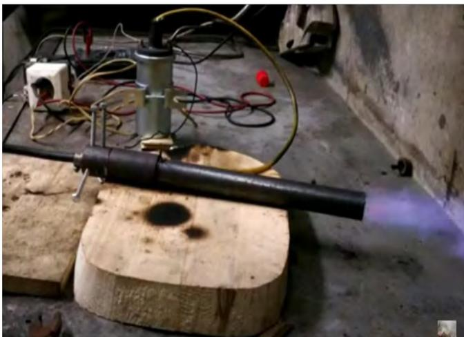
Рис. № 17.3. Трубчатый источник вол детонационного горения.
