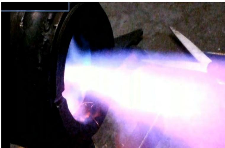
Рис. № 20.3. Детонационно-резонансное разложения оксидов металлов до металлов в волне детонационного горения в начальной стадии распространения.
