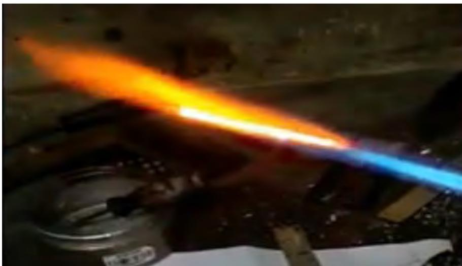
Рис. № 8.1. Само распространяющийся высокотемпературный синтез (СВС) огнестойкого защитного покрытия на стальном прутке.
