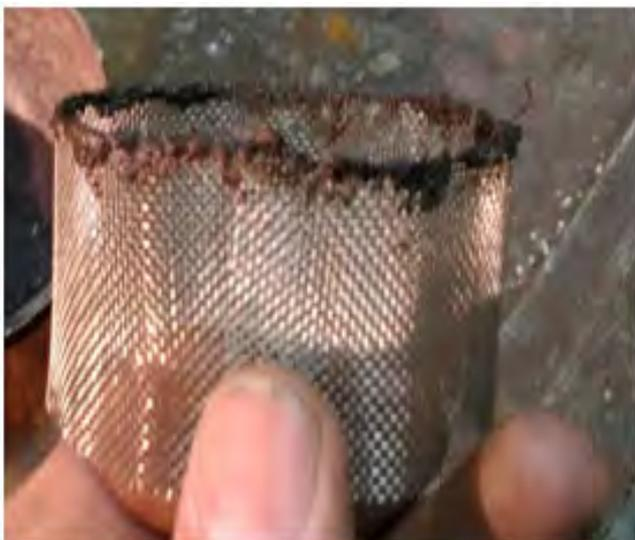
Рис. № 19.2. Пример ввода порошка оксида металла во фронт детонационного горения посредством стальной сетки.
