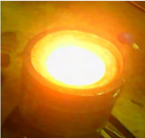
Рис. № 10.2. Само распространяющийся высокотемпературный синтез (СВС) полочек под нагревательную спираль внутри печи.
