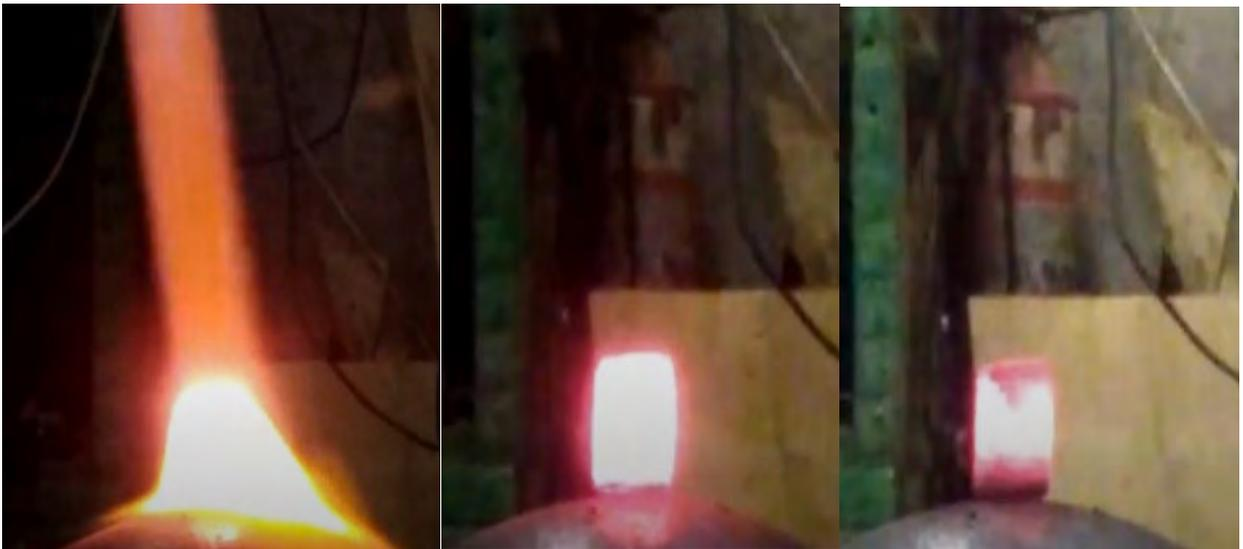
Рис. № 10.1. Само распространяющийся высокотемпературный синтез (СВС) огнеупорного изделия.
