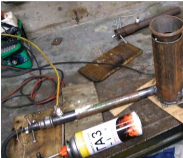
Рис. № 17.6. Схема вихревой трубы с питанием от источника волн детонационного горения.
