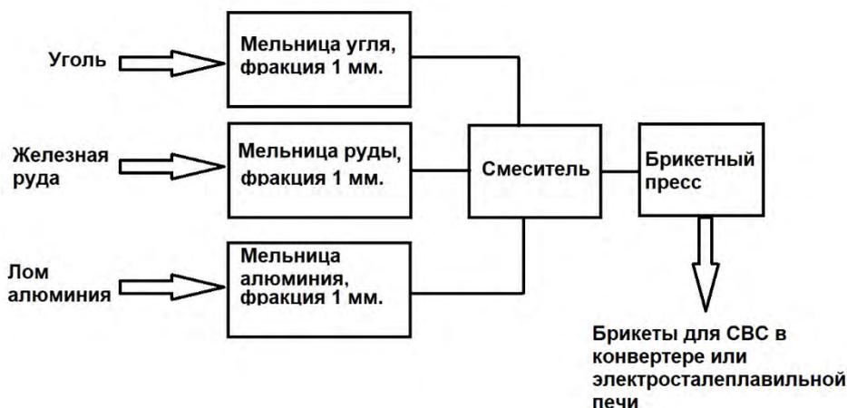
Рис. № 12.1. Технология производства брикетов для СВС карбида железа.
