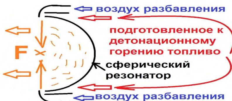
Рис. № 16.12. Упрощённый вид детонационно-резонансной горелки.
