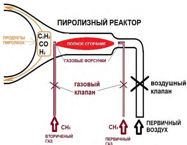
Рис. № 16.17. Двухэтапный окислительный пиролиз с вводом в продукты полного сгорания новой порции топлива.
