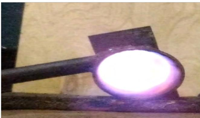
Рис. № 17.5. Тангенциальное распространение волны детонационного горения.
