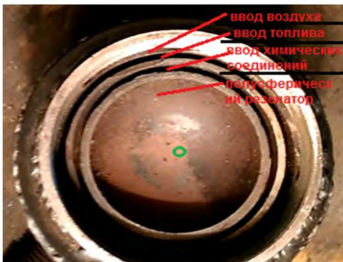
Рис. № 20.2. Конструкция полусферического резонатора с дополнительным вводом продуктов для термического разложения.
