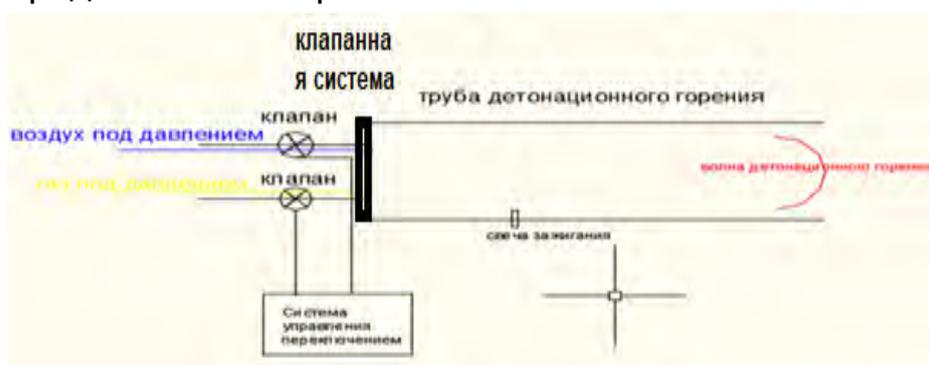
Рис. № 16.3. Вариант установки много клапанной системы в торцевую часть трубчатого детонационного источника энергии.
