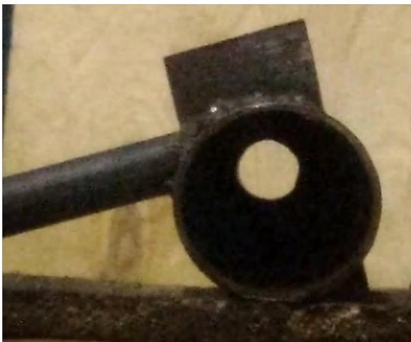
Рис. № 17.2. Стапель исследования тангенциального распространения волны детонационного горения.
