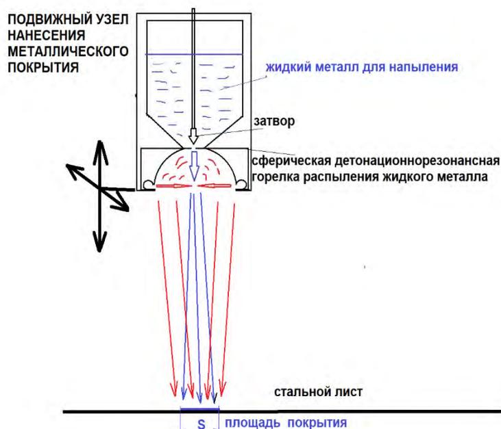
Рис. № 6.1. Квазиимпульсная технология напыления защитных металлических покрытий.
