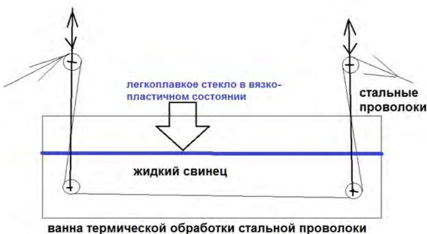
Рис. № 2.1. Технология исключения образования изгари.
