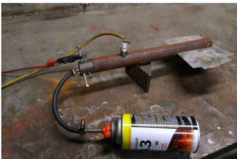
Рис. № 5.4. Стенд исследования воздействия волн детонационного горения на цинковое покрытие стального листа.
