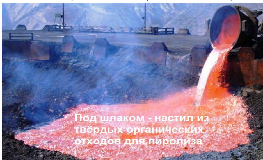
Рис. № 3.1. Технология восстановления металлов из оксидов сталеплавильного шлака.
