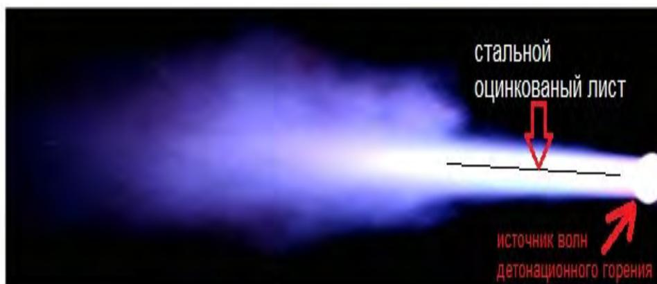
Рис. № 5.2. Размещение стального листа в волне детонационного горения.
