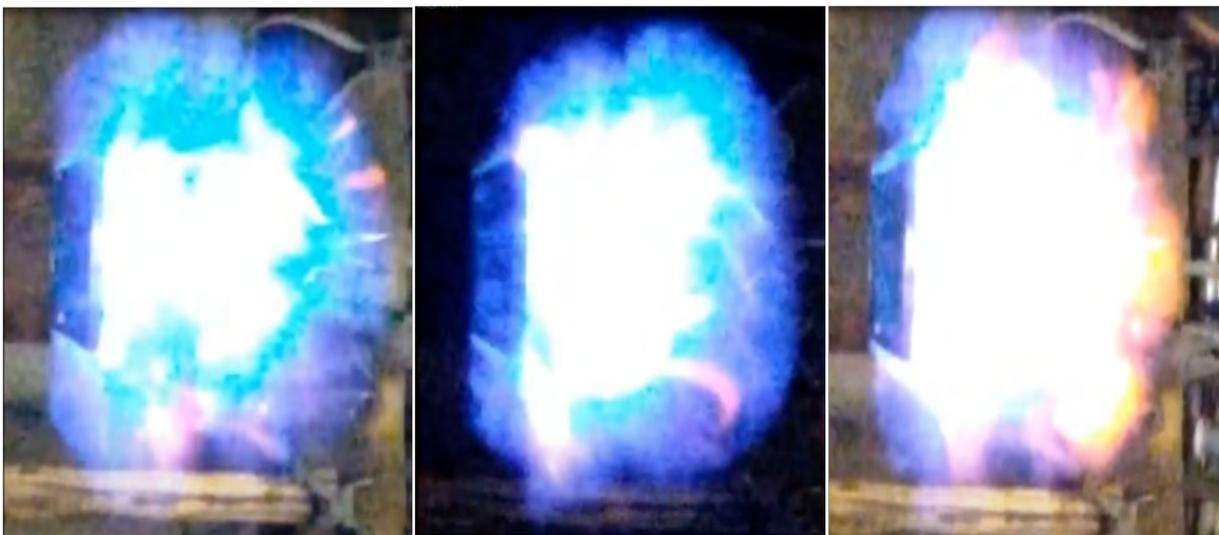
Рис. № 17.7. Визуализация двух потоков детонационного горения с выхода “холодной” и “горячей” части вихревой трубы.
