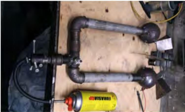
Рис. № 21.2. Стенд исследования схлопывания двух волн детонационного горения.
