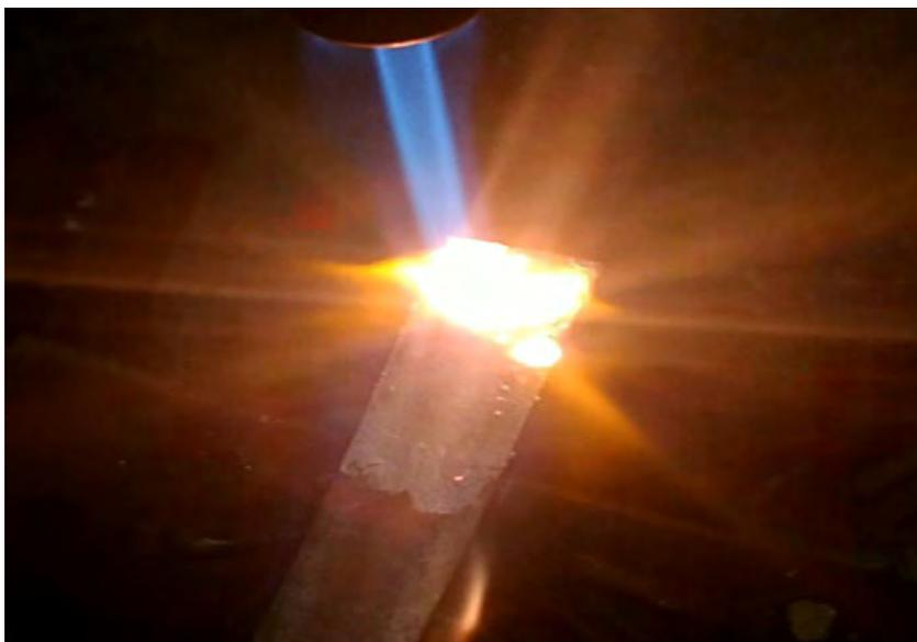
Рис. № 9.1. Самораспространяющийся высокотемпературный синтез (СВС) защитного покрытия поверхности стальной заготовки от высокотемпературной газовой коррозии.
