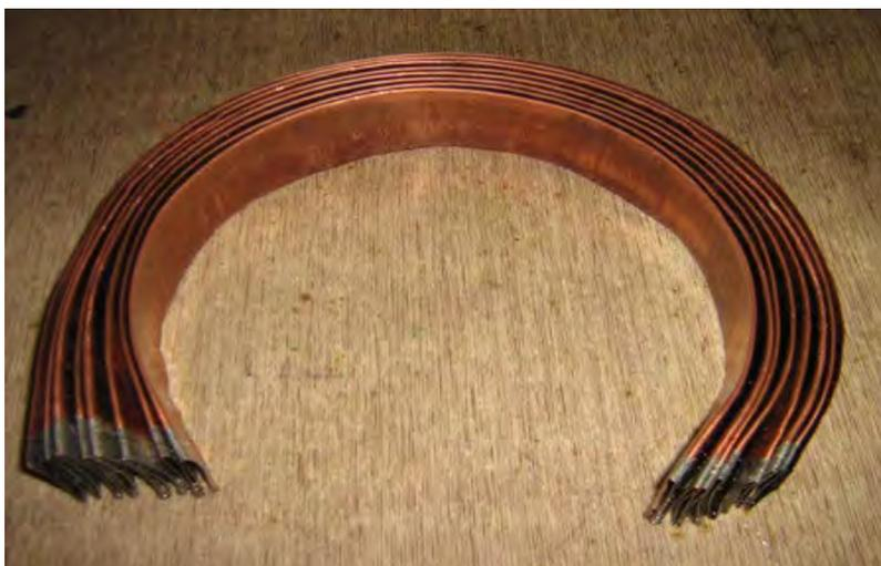
Рис. № 12.5.10. Удаление прокладочной стальной ленты.
