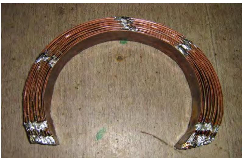
Рис. № 12.5.11. Заключительный этап – пайка радиатора.
