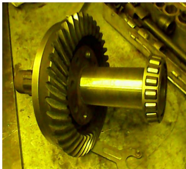
Рис. № 10.1.4. Выходной вертикальный вал редуктора.
