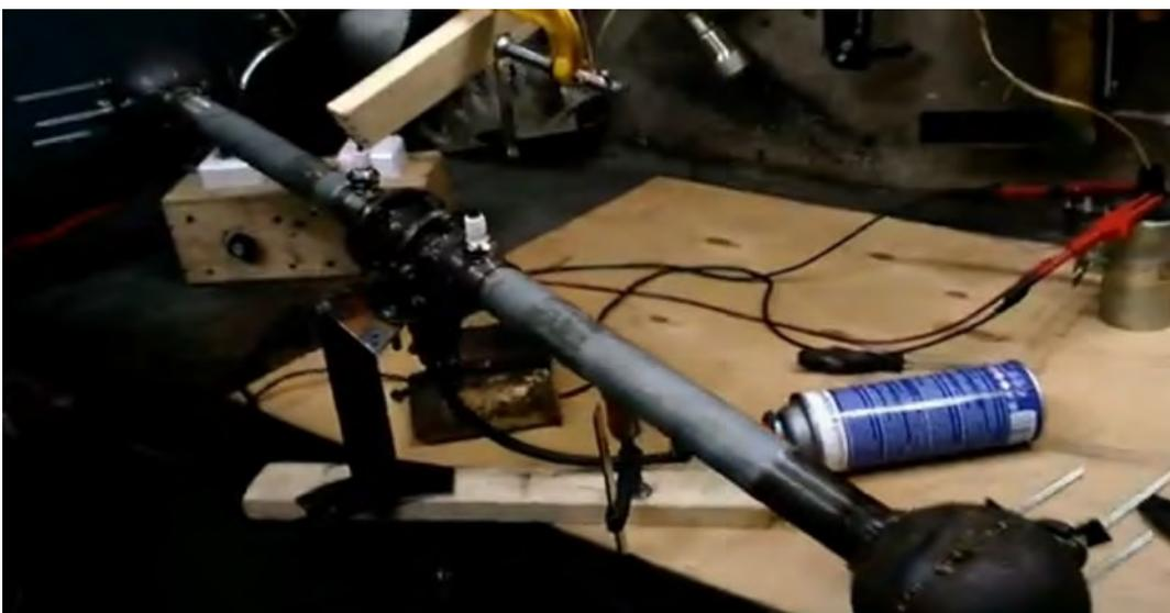
Рис. № 7.3. Стенд исследования детонационного эффекта Коанда для привода винта вертолѐта.
