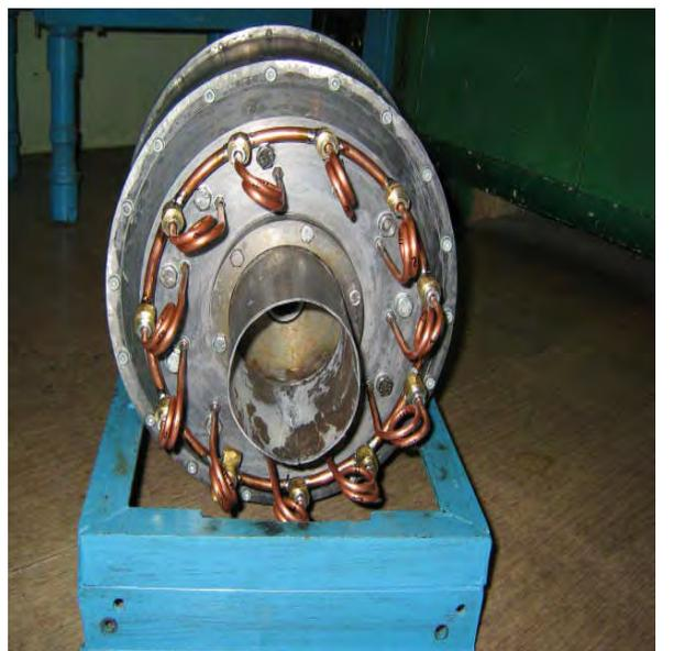
Рис. № 12.2. Внешний вид газотурбинного двигателя в сборе
