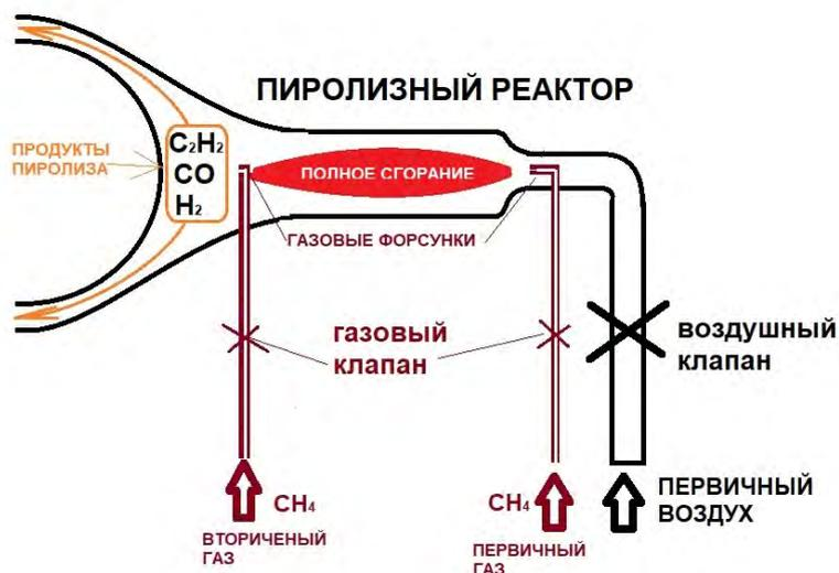
Рис. № 4.4. Двух этапный окислительный пиролиз (не полное сгорание топлива с вводом в продукты не полного сгорания новой порции топлива).
