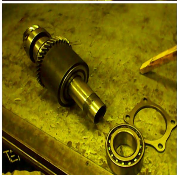
Рис. № 10.1.5. Промежуточный вал с обоймой обгонных муфт
