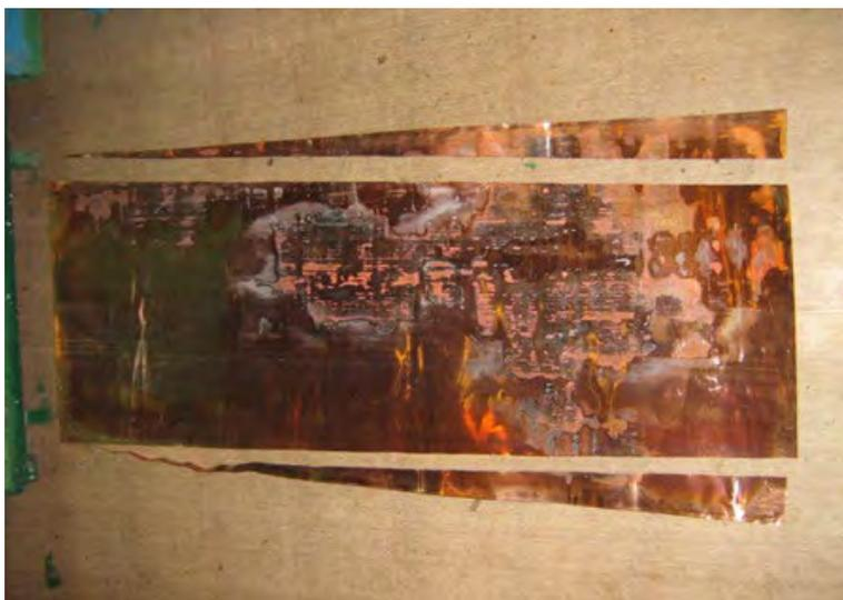
Рис. № 12.5.3. Лист меди размечен и разрезан в размер.
