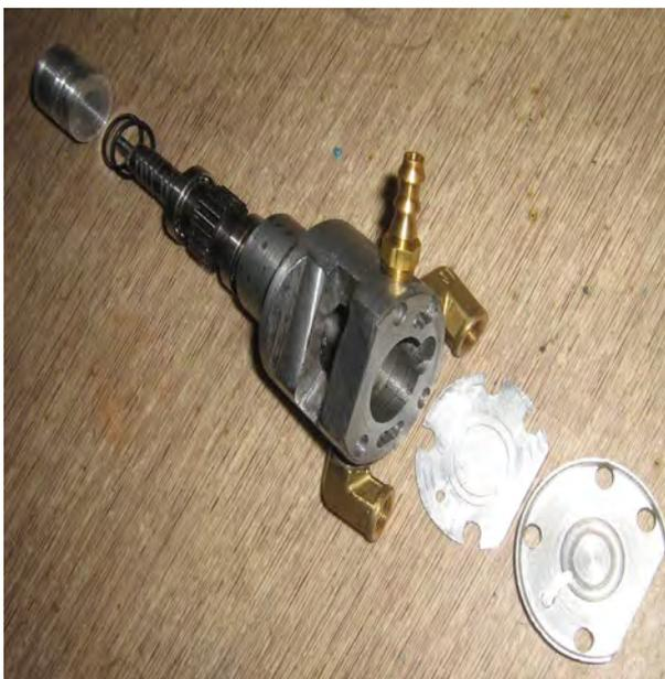
Рис. № 12.10.2. Части редуктора.
