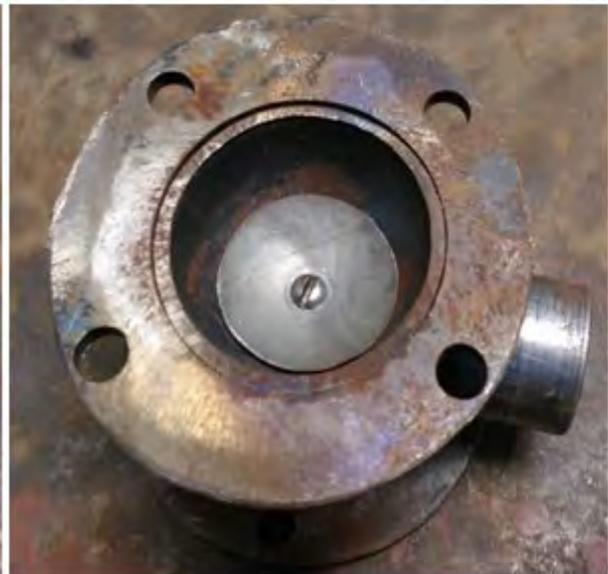
Рис. № 6.3. Взаимосвязанные клапаны управления детонационным горением.
