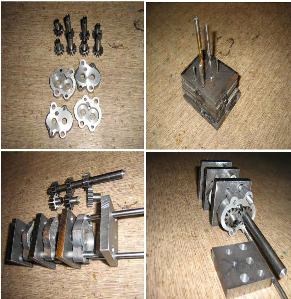
Рис. № 12.2.1 Пакетная сборка трёх комплектов масляного насоса мотоцикла УРАЛ.
