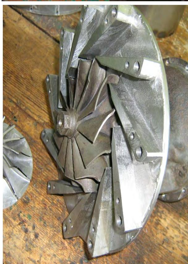
Рис. № 12.9.1. Выходной радиальный направляющий аппарат
