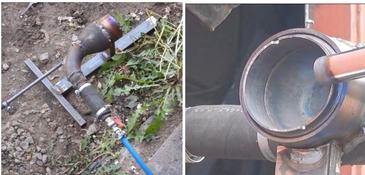
Рис. № 3.3. Внешний вид дефлаграционно-резонансного двигателя.
