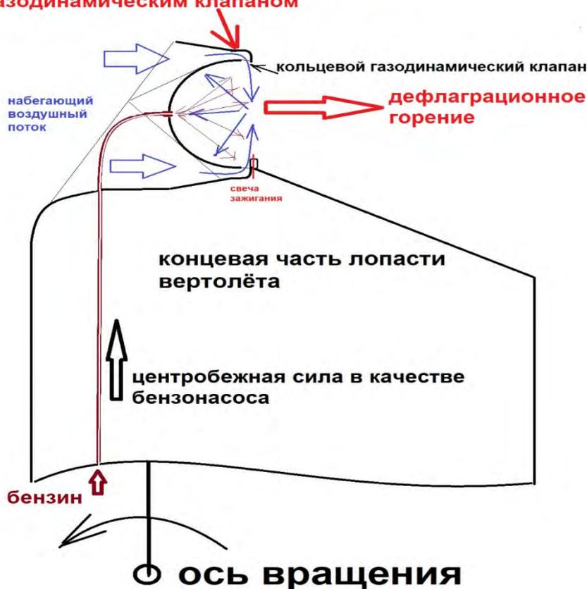
Рис. № 3.1. Полусферический реактивный двигатель, предложен Поповым Николаем Ивановичем.
