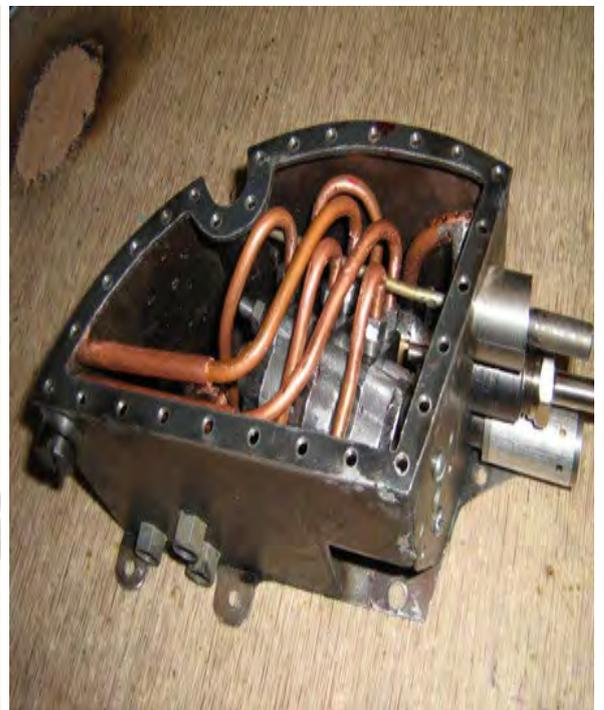
Рис. № 12.2.2. Внешний вит масляного трёх секционного насоса
