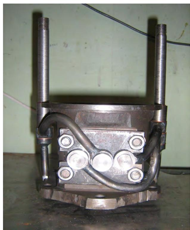
Рис. № 12.1.2. Система смазки в сборе.
