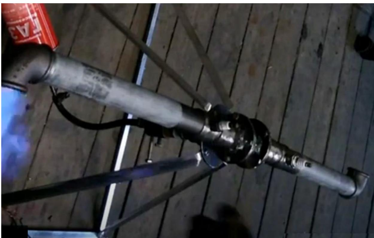
Рис. № 6.4. Стенд исследования детонационного привода лопастей вертолѐта
