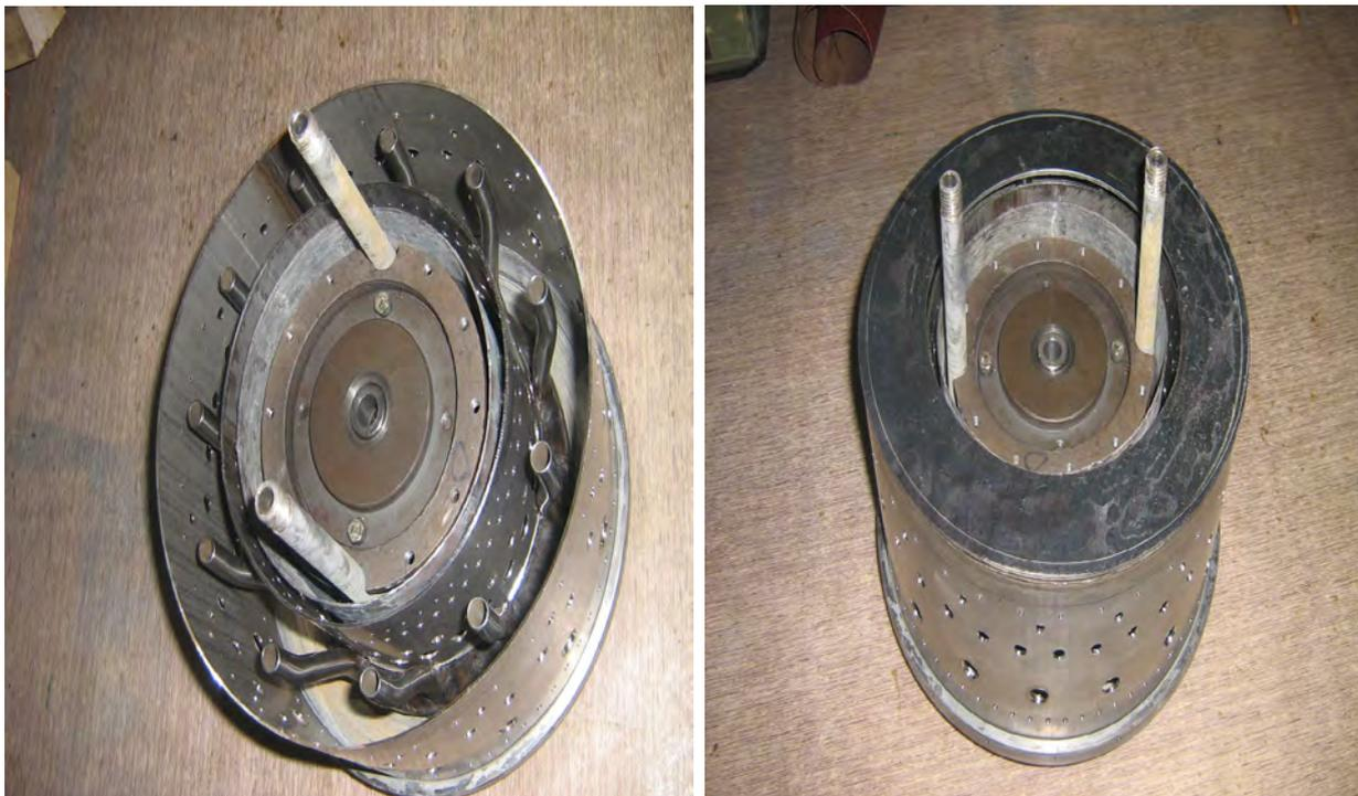
Рис. № 12.11.2. Камера сгорания в сборе.
