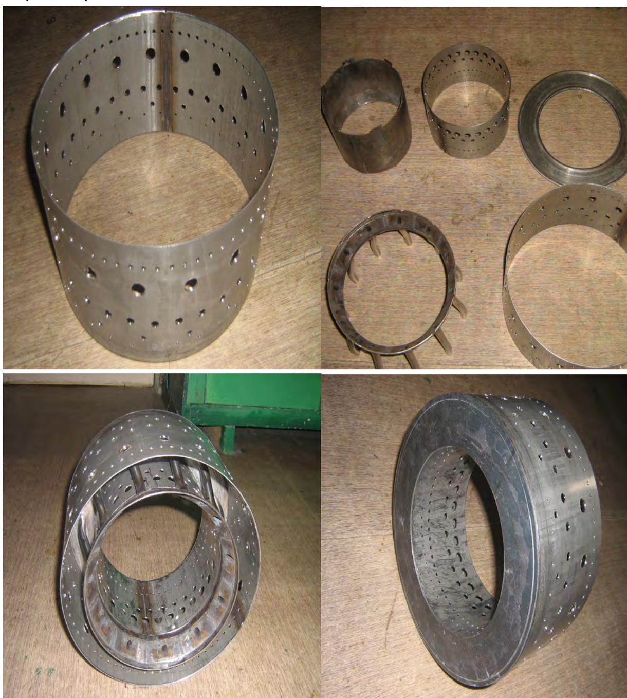
Рис. № 12.11.1. Части камеры сгорания
