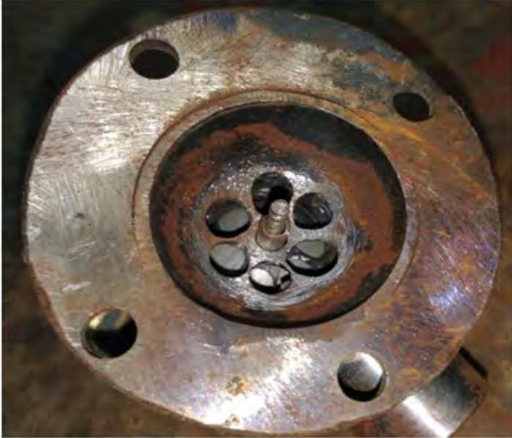
Рис. № 6.2. Конструктивное исполнение одного полу шарового клапана
