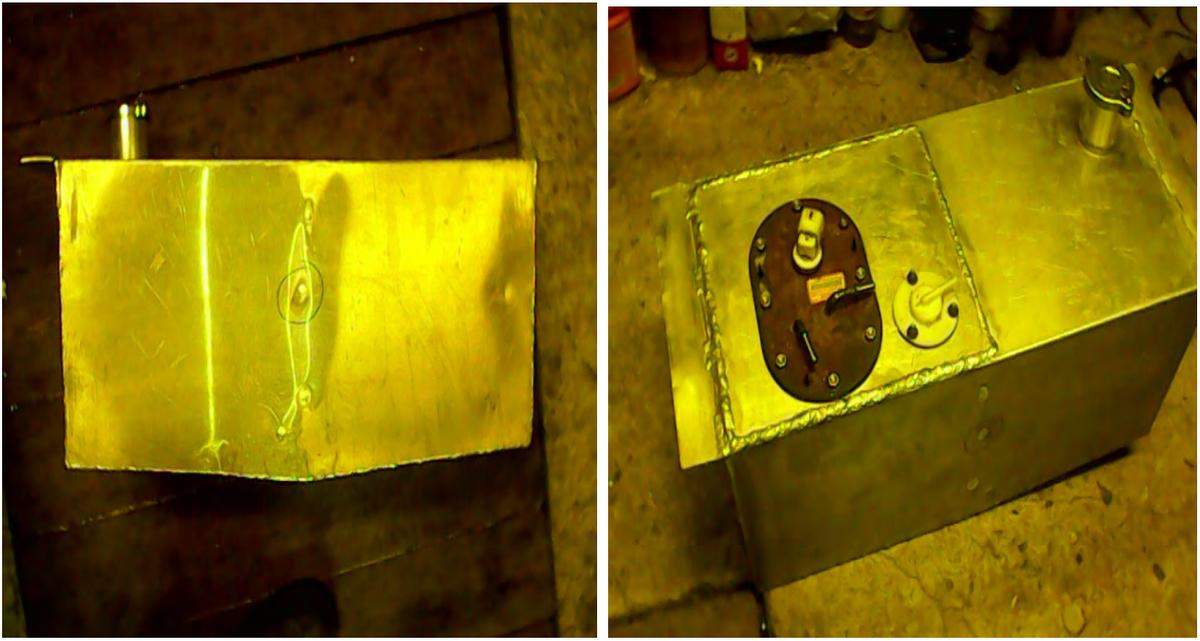
Рис. № 10.2.3. Топливный бак в сборе с топливным насосом
