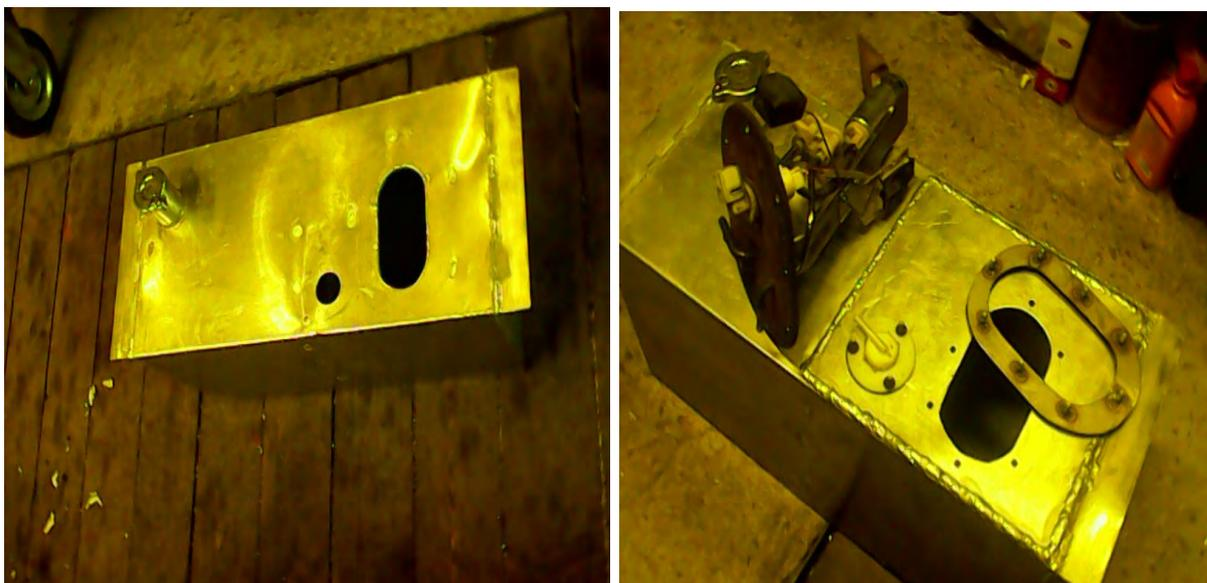
Рис. № 10.2.2. Топливный бак с фланцем установки топливного насоса.
