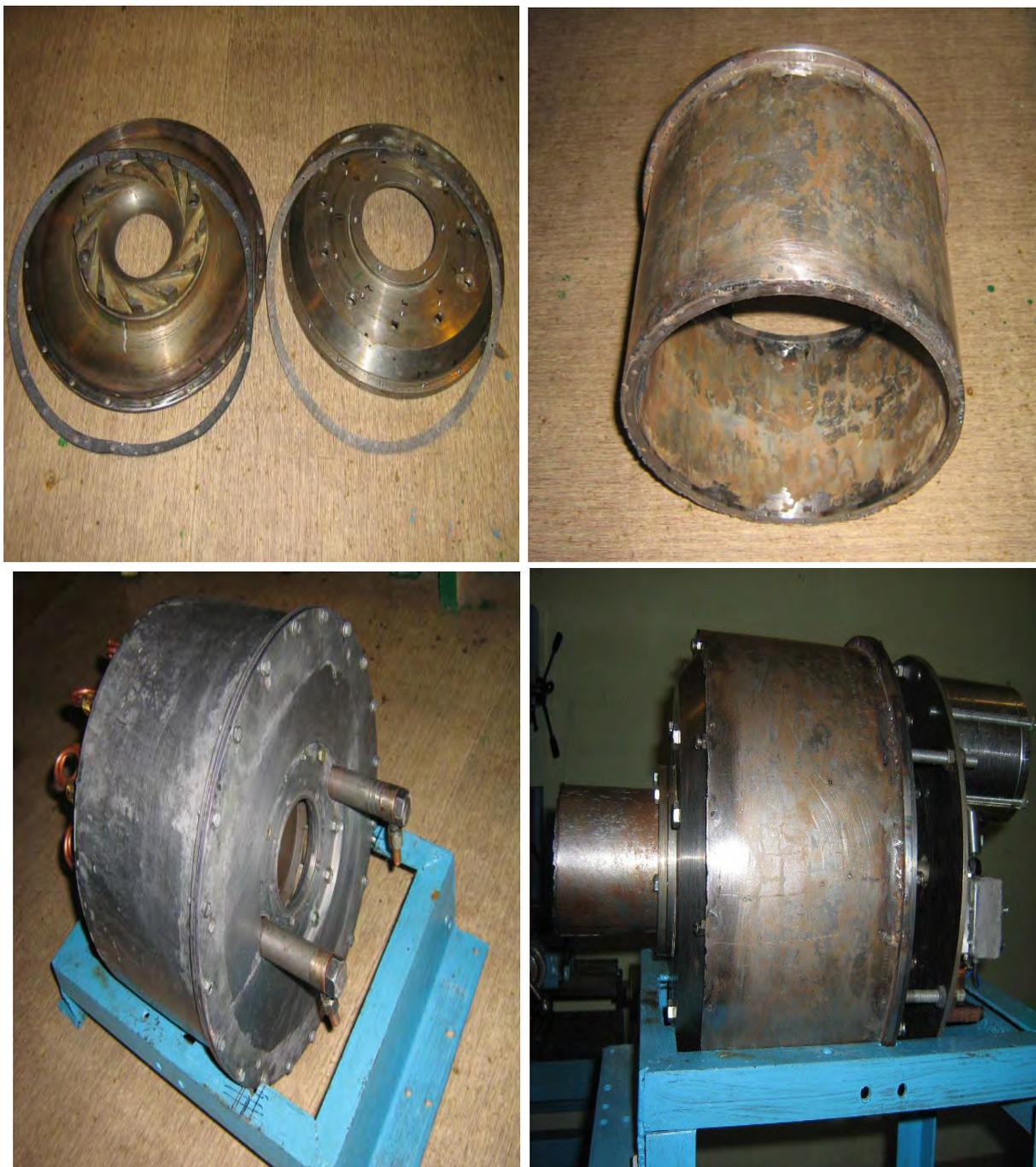
Рис. № 12.8. Корпус турбореактивного двигателя.
