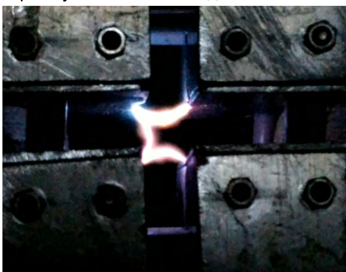
Рис. № 3.6. Распространение разрядов в додекапольном конденсаторе.
