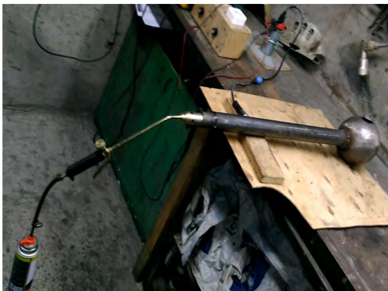
Рис. № 4.6. Прототип генератора со сферическим резонатором диаметром 0,15 м.
