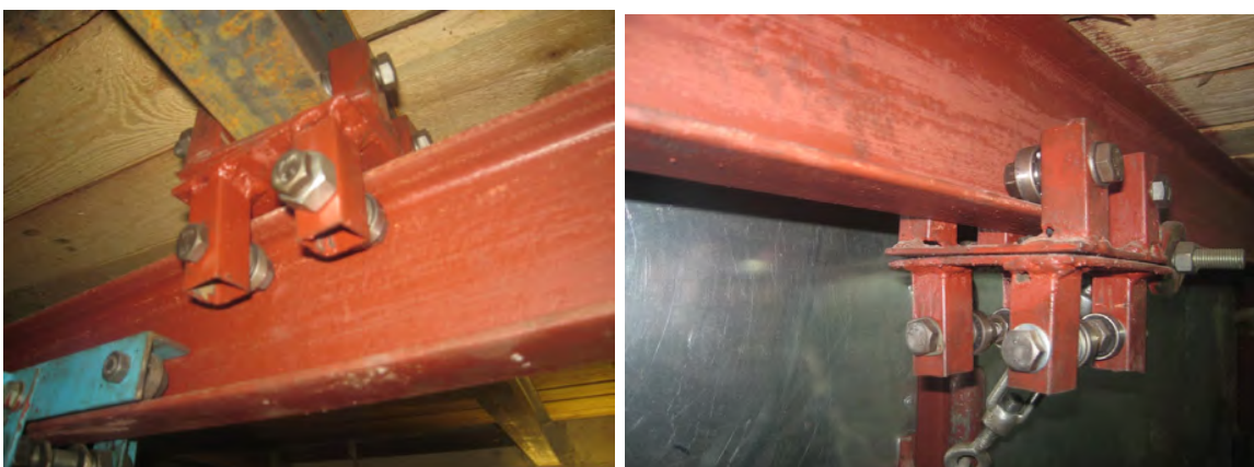
Рис. № 1.3. Поворотные роликовые опоры подвижной кран-балки.
