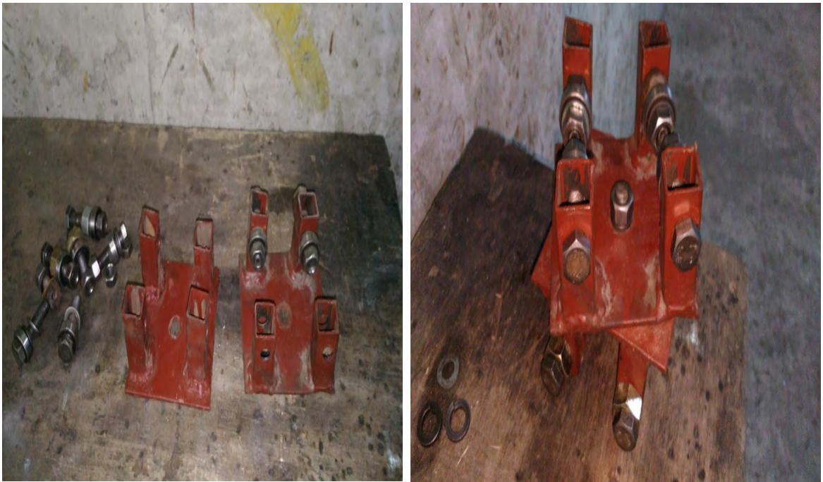
Рис. № 1.4. Сборка поворотной роликовой опоры
