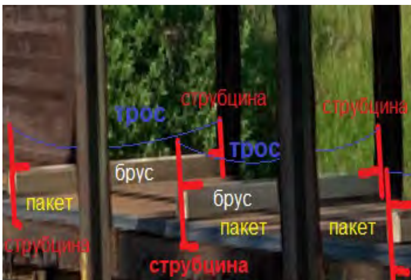
Рис. № 6.4. Схема крепления прокладочного бруса к пакету листовой стали системой из двух взаимосвязанных струбцин.
