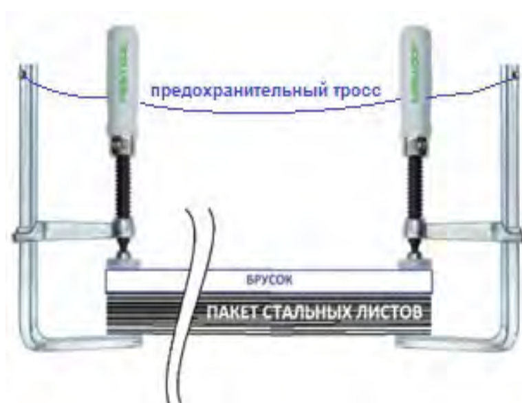
Рис. № 6.3. Быстрозажимные струбцины для быстрой фиксации бруска с пакетом стальных листов.
