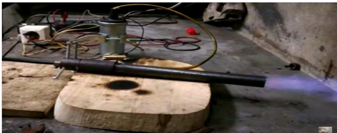
Рис. № 3.2. Источник волны детонационного горения – трубчатая импульсная детонационная горелка.
