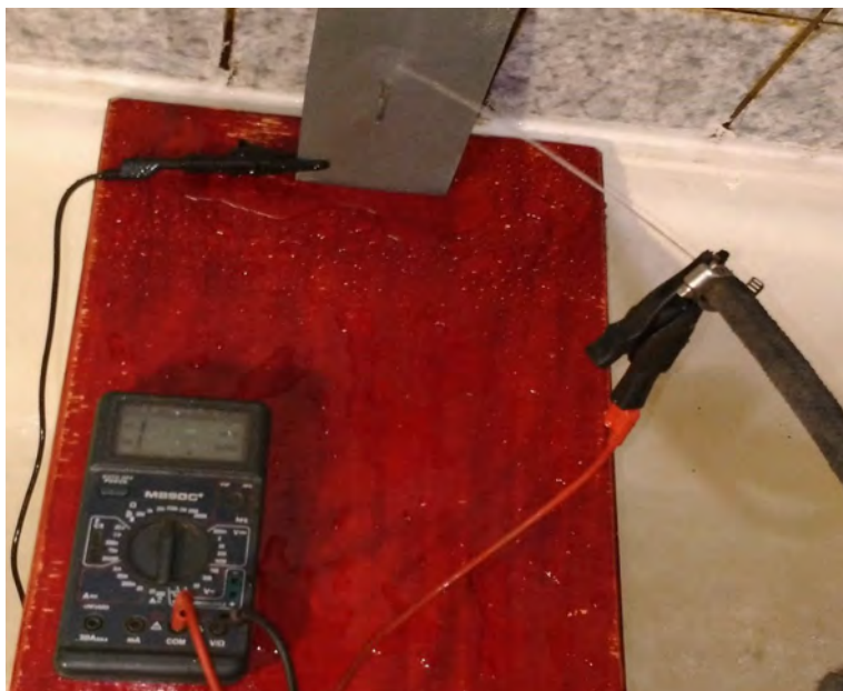
Рис. № 2.2. Эксперимент по измерению сопротивления струи жидкости на постоянном токе.
