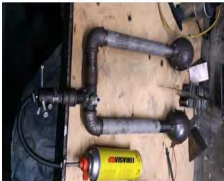
Рис. № 7.1. Испытательный стенд из двух источников волн детонационного горения.
