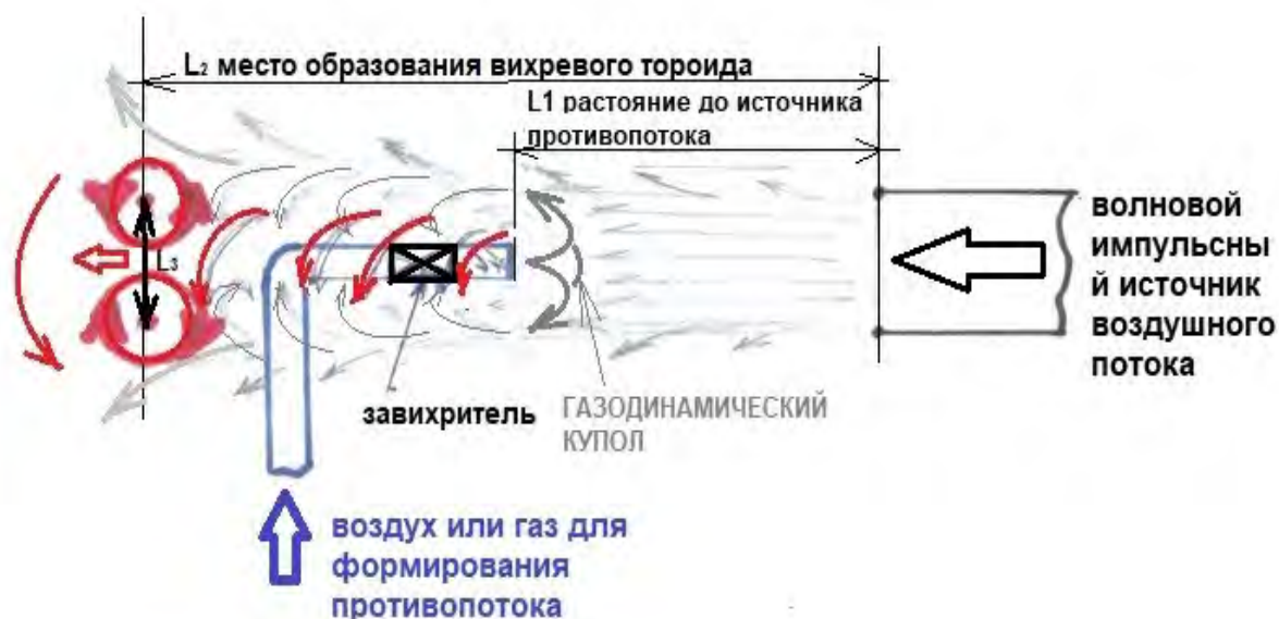
Рис. № 8.4. Способ формирования обратного ротационного вихревого тороида.
