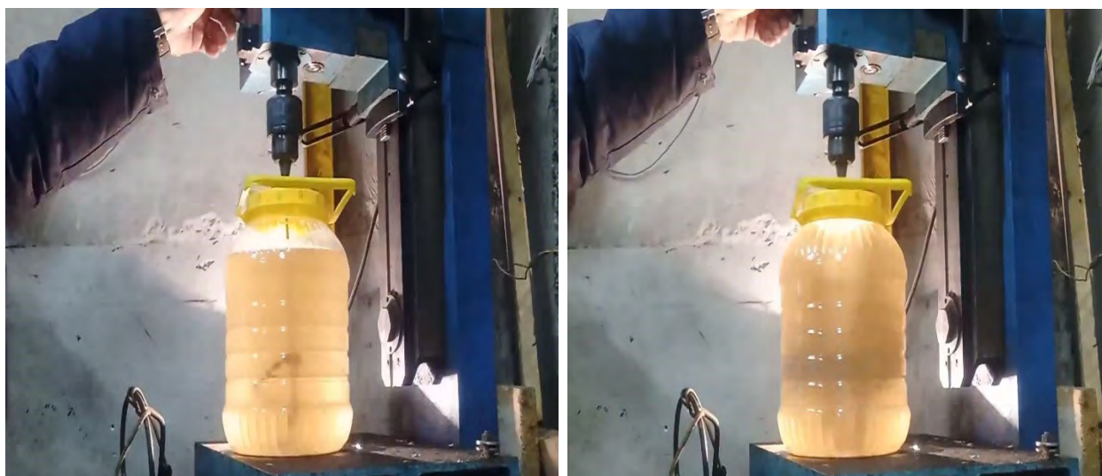
Рис. 1. Эксперимент само балансировки тонкого длинного ротора.
