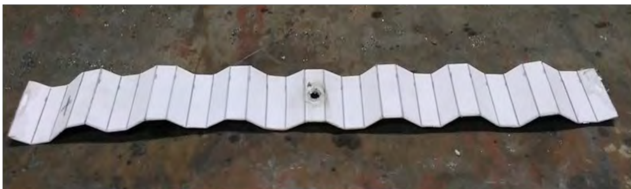
Рис. № 6.1. Вибро-ротационный винт “полу сотового” продольного профиля
