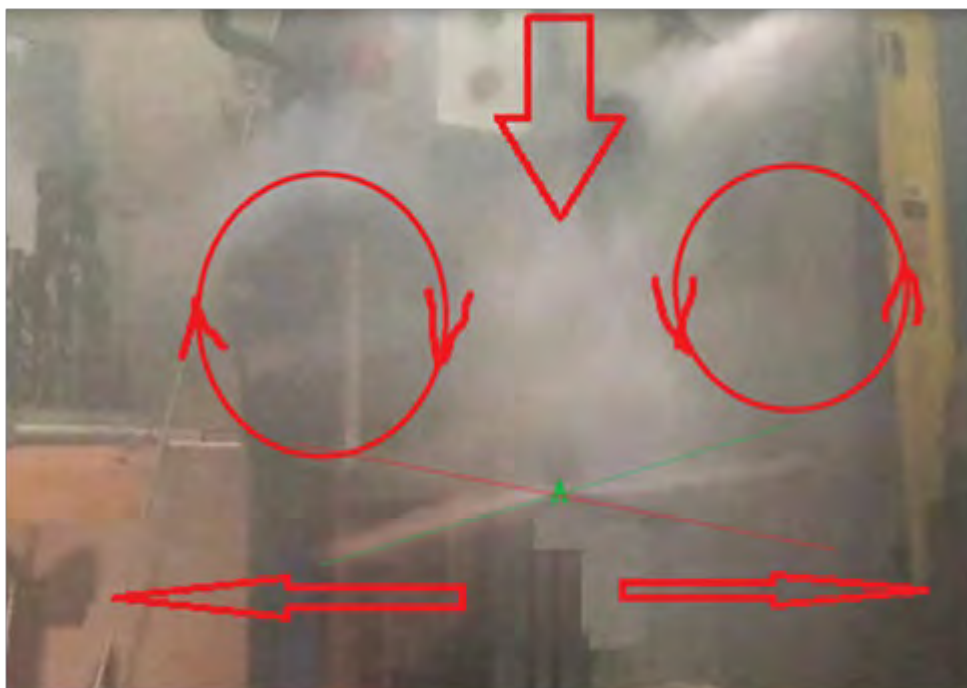
Рис. № 6.4. Визуализация вихревого тороида выше оси вращения.
