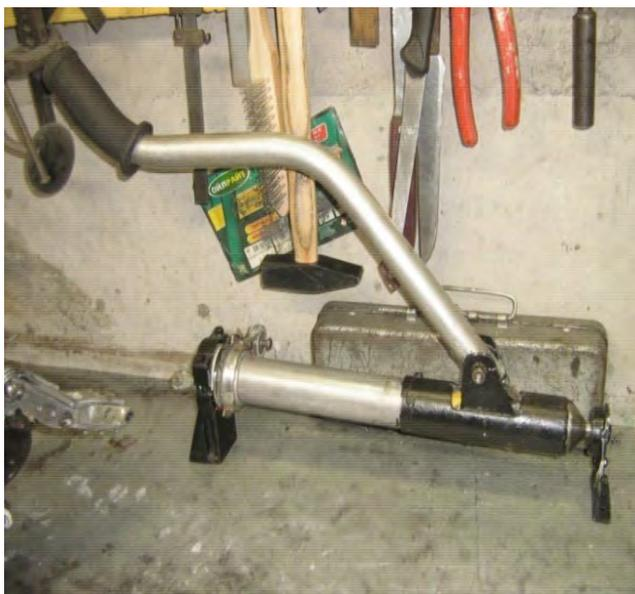
Рис. № 2.4.2. Конструктивное исполнение ручки циклического шага.
