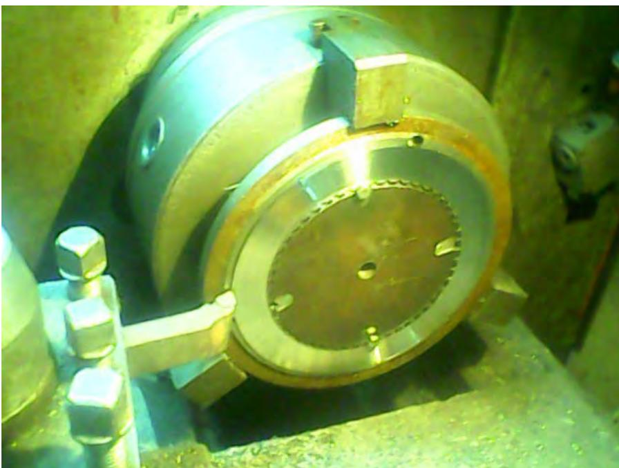
Рис. № 3.10.3. Проточка тормозного диска демпфера до толщины 0,8 мм.
