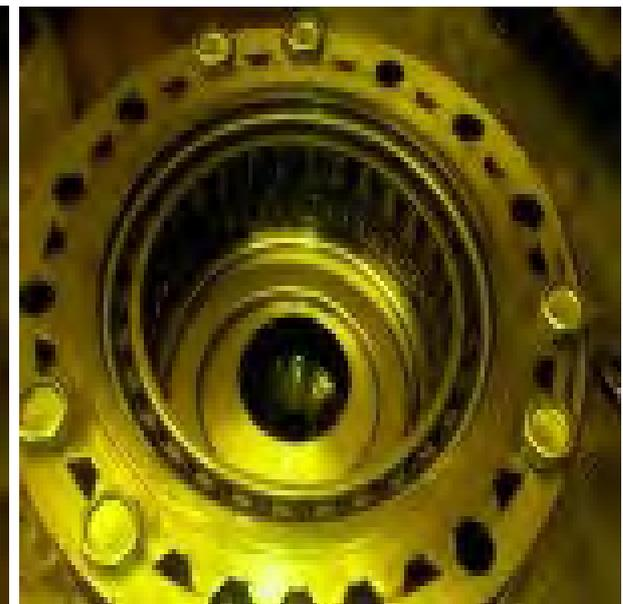
Рис. № 2.10.2. Обгонная муфта с шестернёй редуктора привода рулевого винта.
