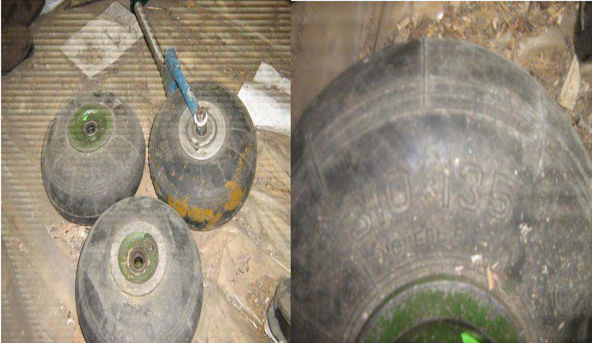
Рис. № 2.13.1. Колёса аэродромной тележки с колёсами 300\*150 мм.
