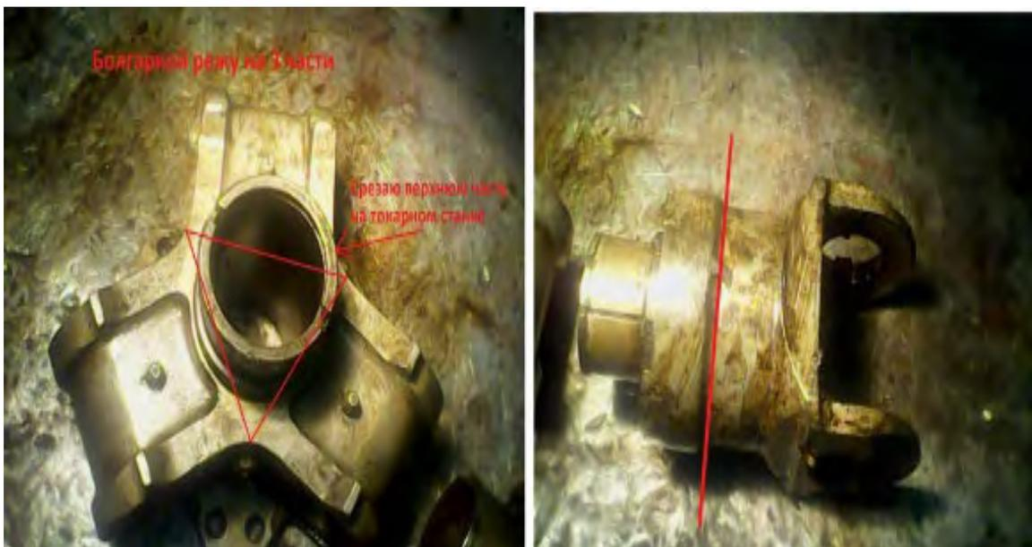
Рис. № 3.9.2. Разметка силовой части рулевой втулки для реза.
