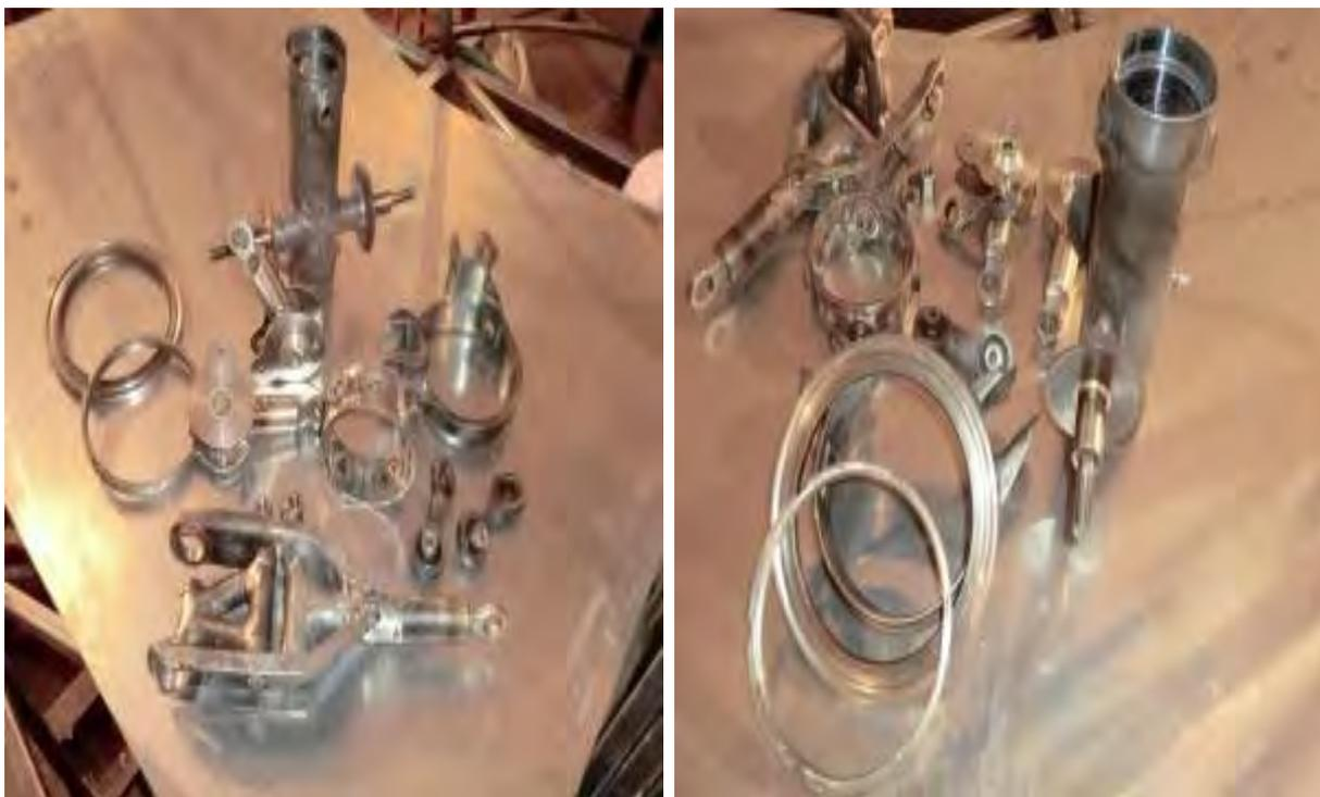
Рис. № 4.3.1. Элементы автомата перекоса.
