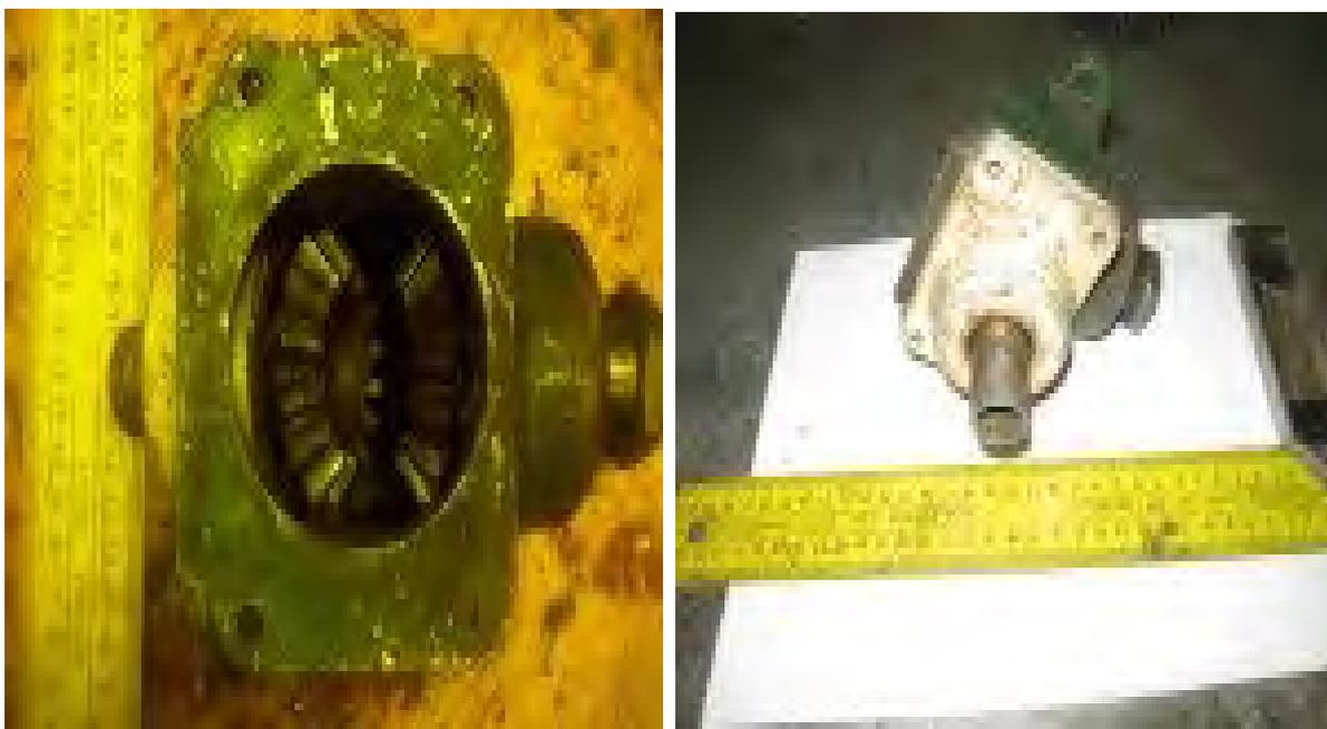
Рис. № 2.11.2. Угловой редуктор привода рулевого винта.
