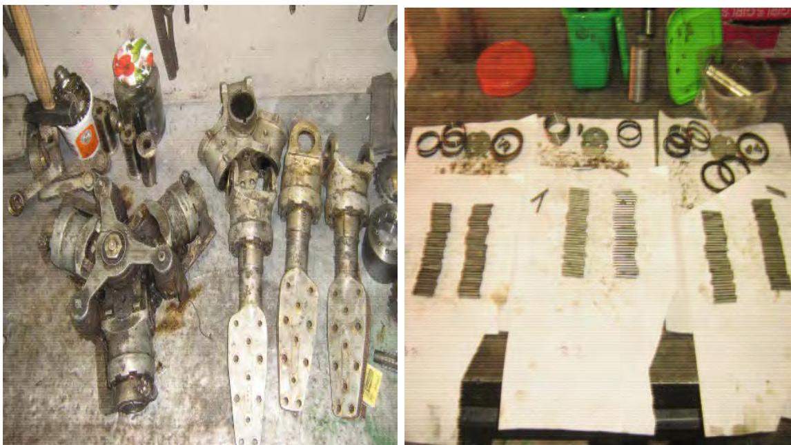
Рис. № 3.9.1. Разборка втулки рулевого винта от МИ-1
