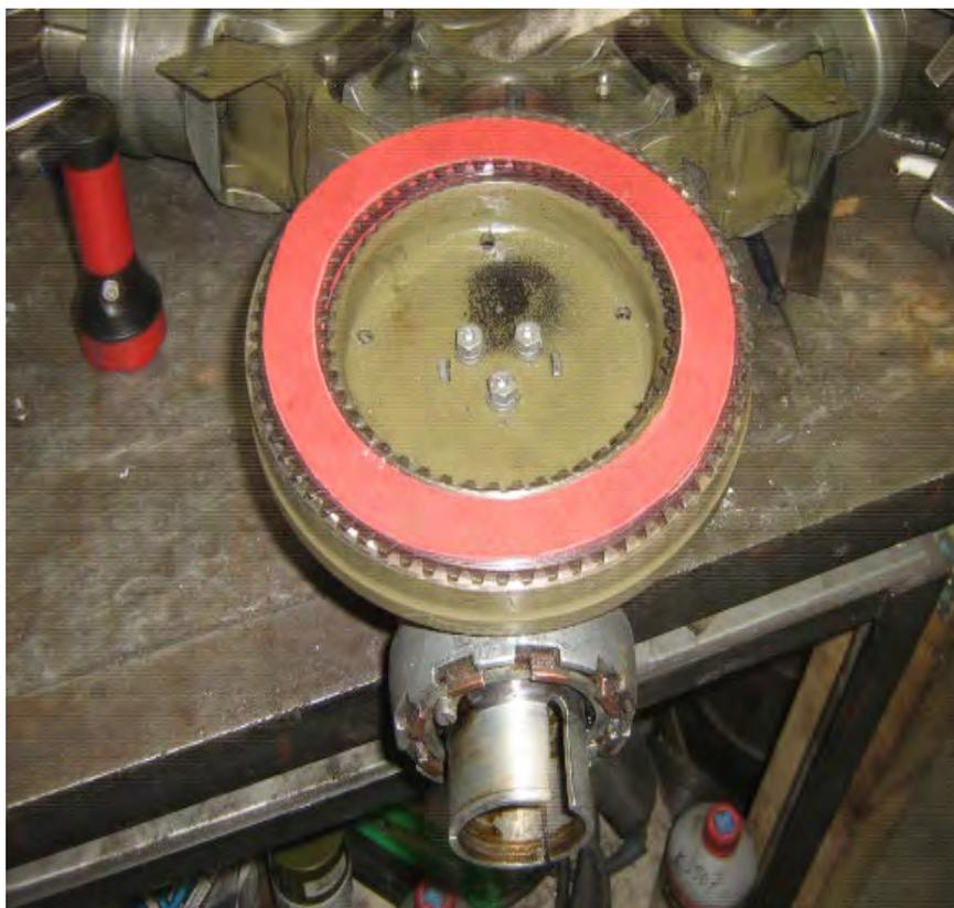
Рис. № 3.10.8. Пакетная сборка демпфера.
