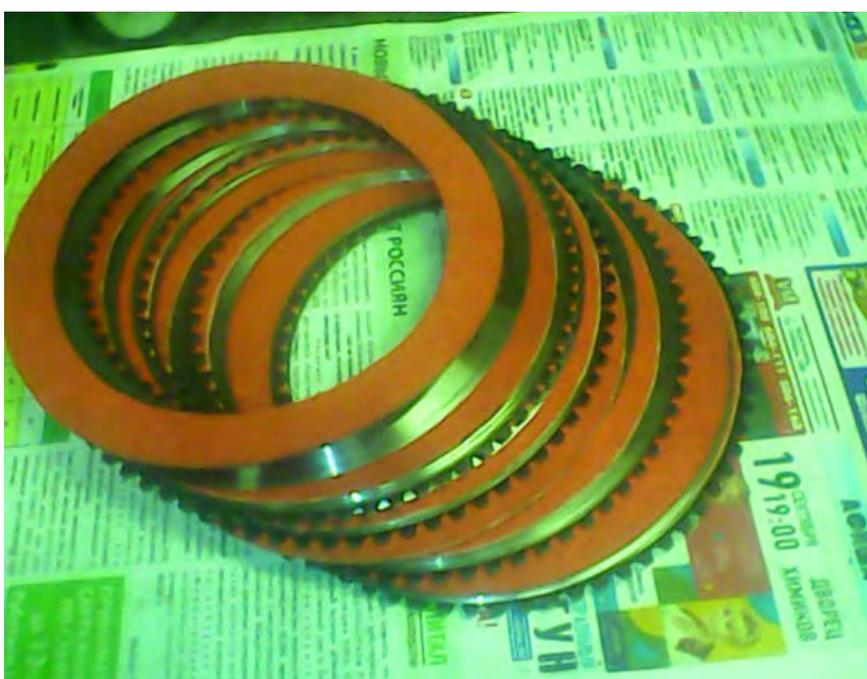
Рис. № 3.10.7. Фрикционные прокладки из фрикционного материала.
