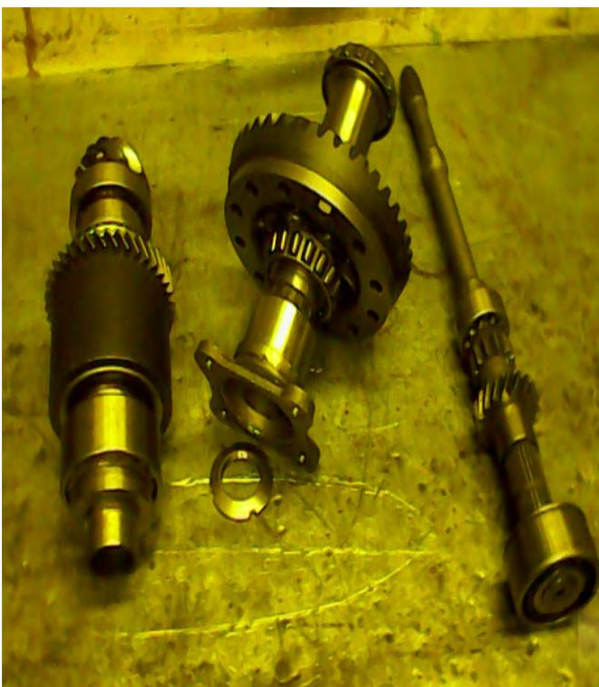
Рис. № 2.15.3. Входного вала, промежуточный вала с обоймой обгонных муфт и выходной вал с большой конической шестернёй.
