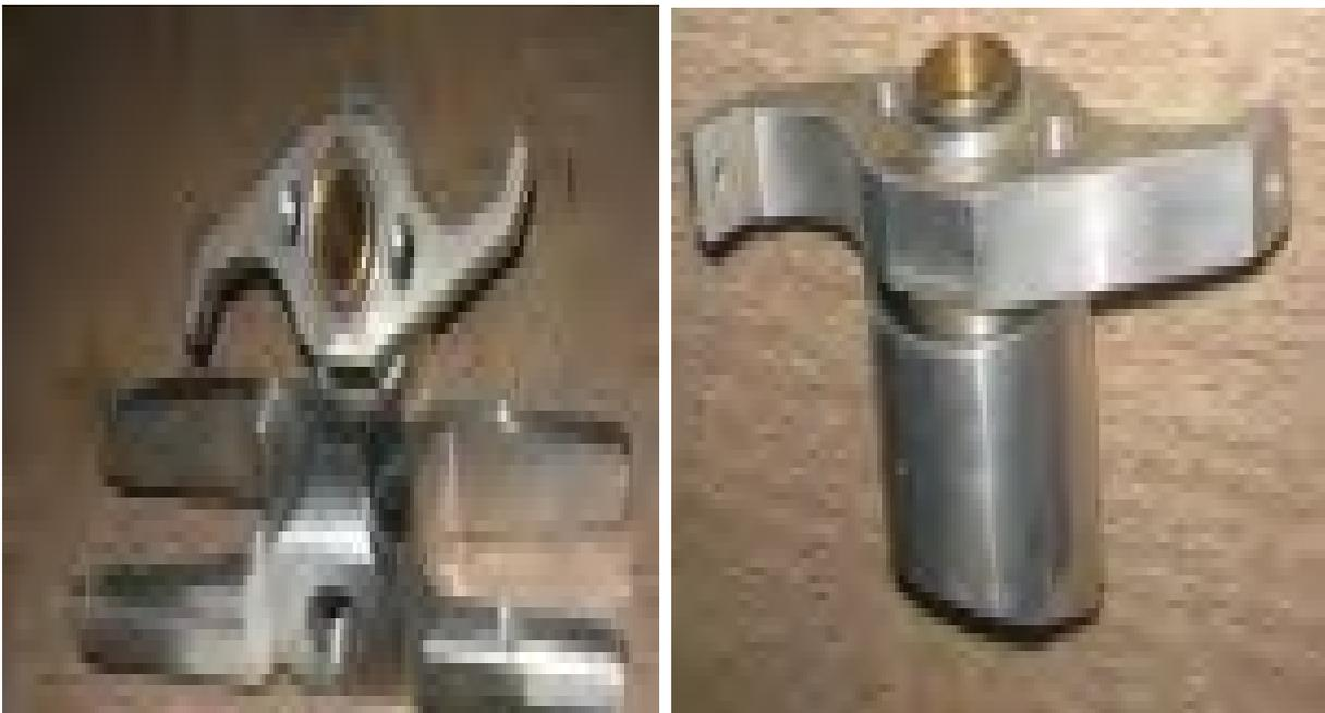
Рис. № 2.9.2. Элементы системы управления общим шагом рулевого винта.
