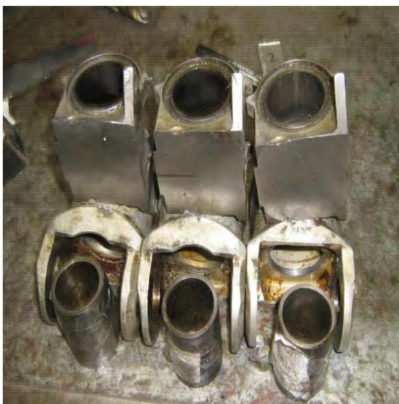
Рис. № 3.9.3. Резка силовой части рулевой втулки с последующим удалением трёх втулок горизонтальных шарниров.
