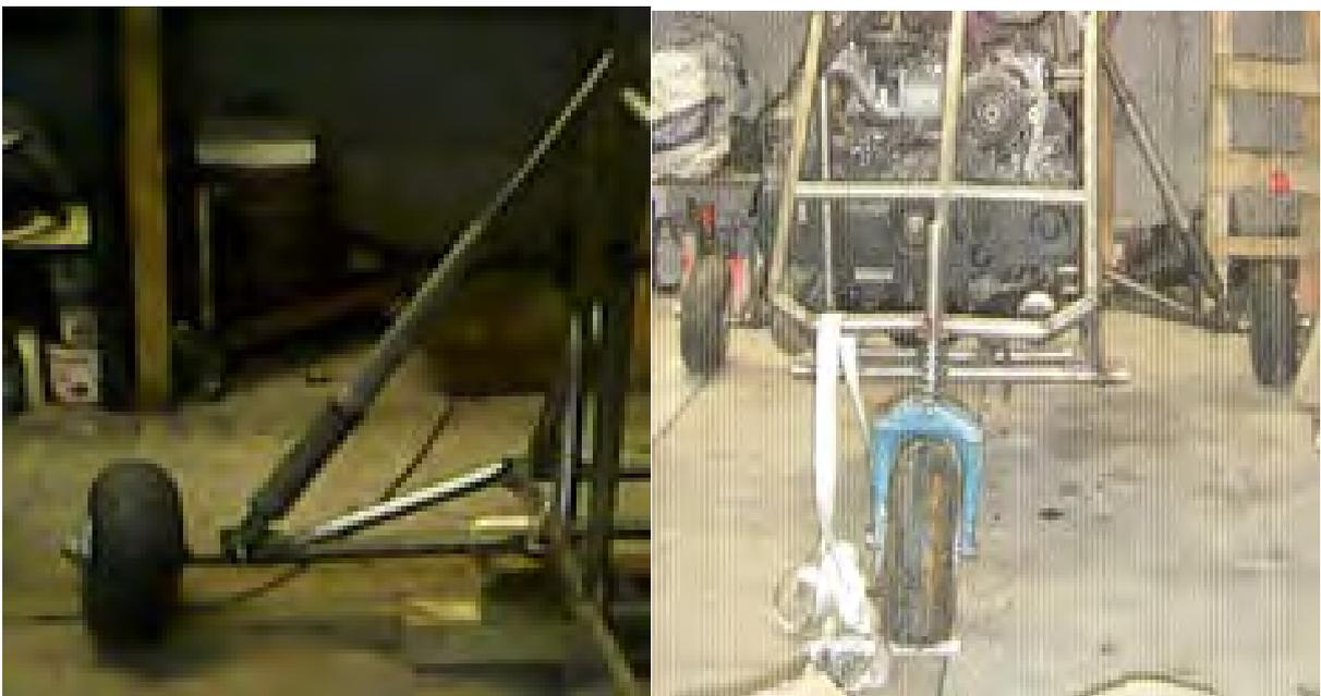
Рис. № 2.13.2. Трёхосное шасси вертолётa.
