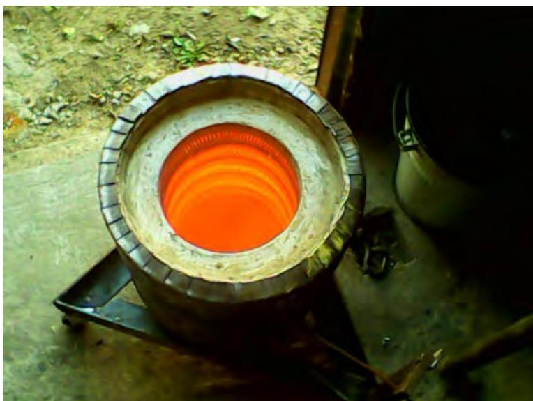
Рис. № 3.9.7. Электрическая печь сопротивления.
