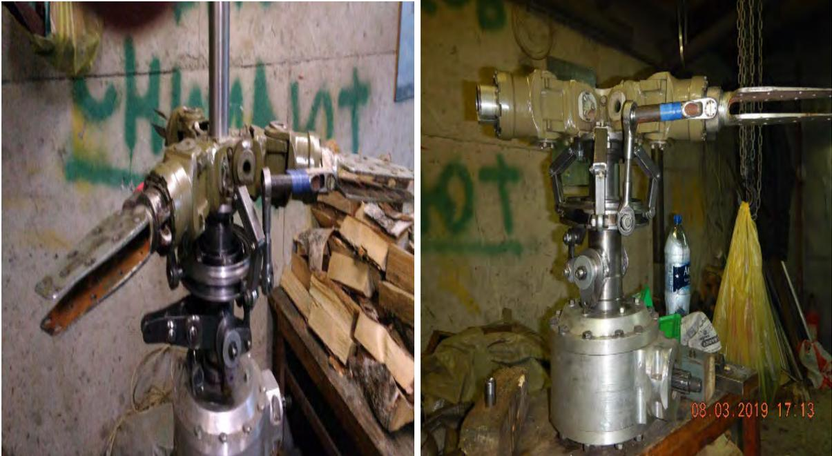
Рис. № 3.4.1. Установка автомата перекоса.
