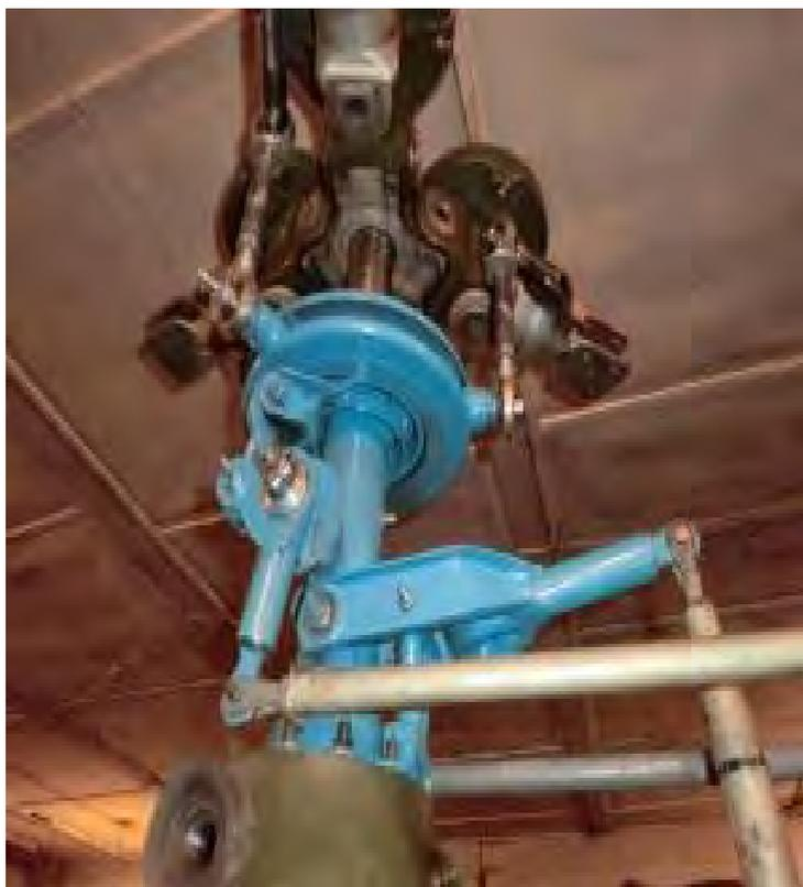
Рис. № 4.3.5. Установка автомата перекоса вертолѣта Горняк.
