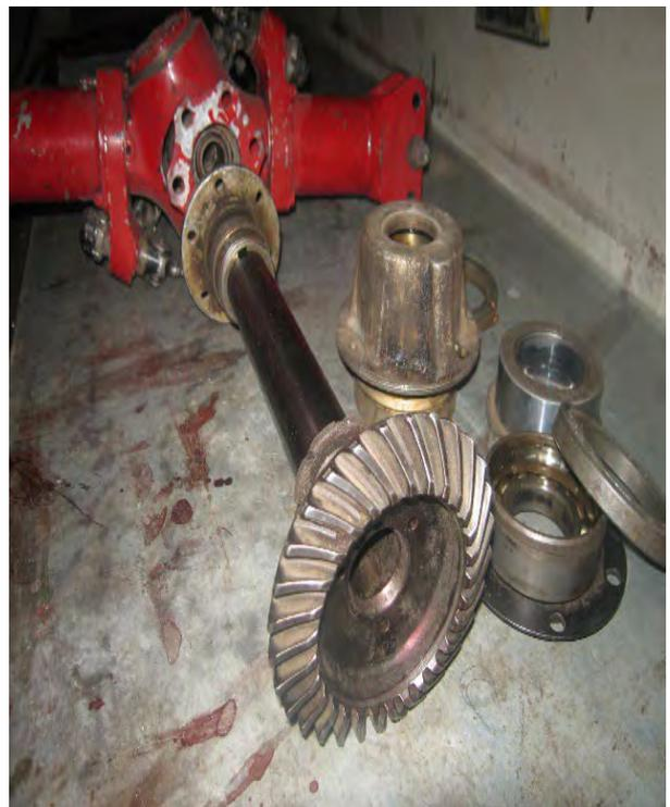
Рис. № 2.8.2. Втулка с приводным валом рулевого винта вертолётa МИ-2.
