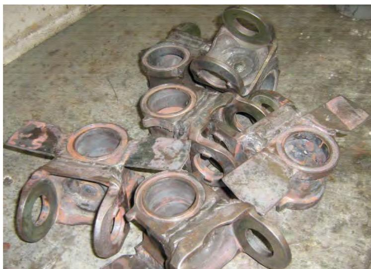
Рис. № 3.9.9. Готовое изделие после термообработки.
