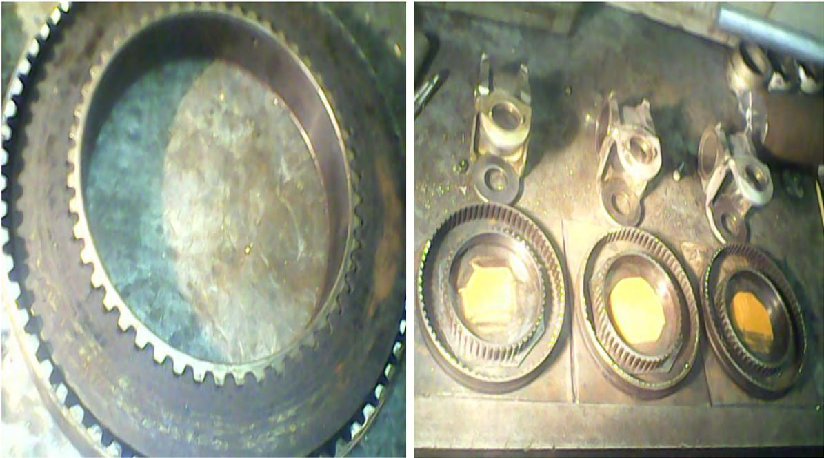
Рис. № 3.10.2. Одной тормозной муфты от редуктора МИ-2 хватает для изготовления трёх идентичных демпферов.
