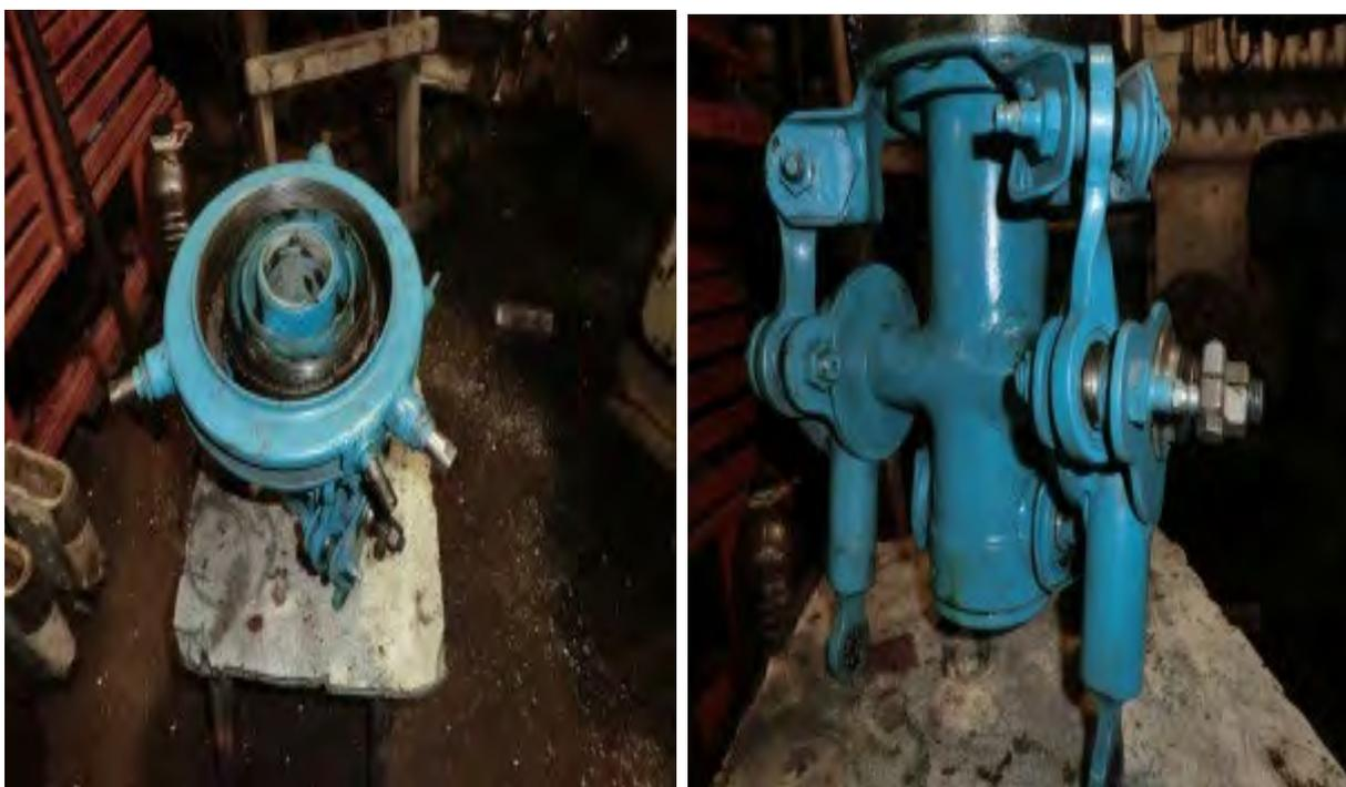
Рис. № 4.3.2. Сборка автомата перекоса.
