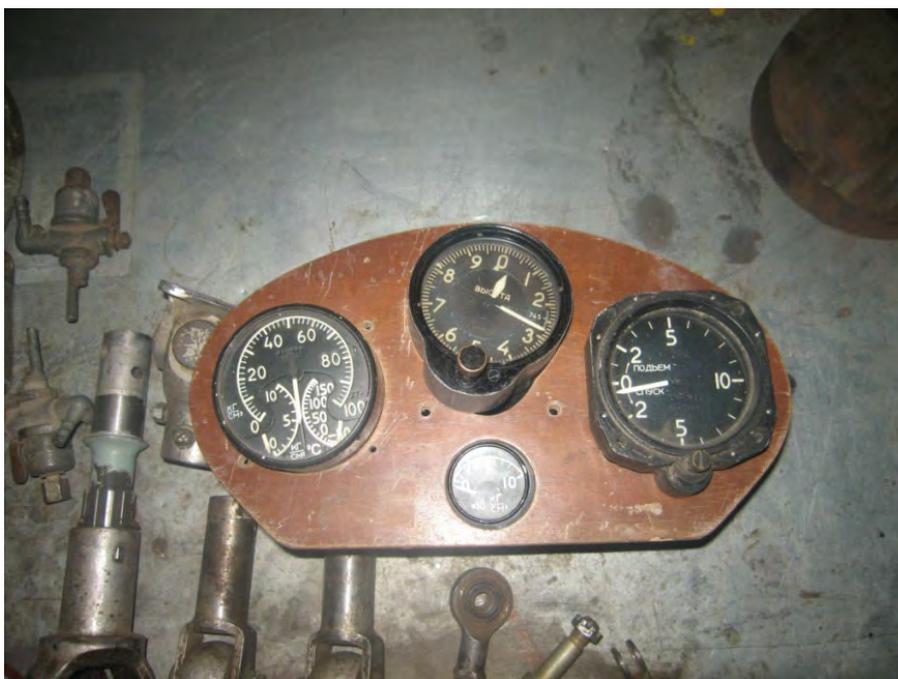
Рис. № 2.12.1. Приборная доска вертолётa.
