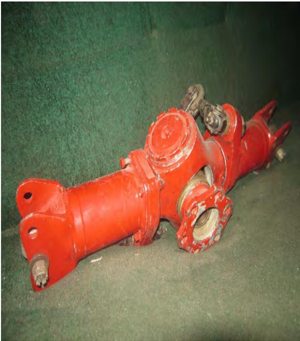
Рис. № 2.8.1. Втулка на торсионах рулевого винта вертолётa МИ-2.
