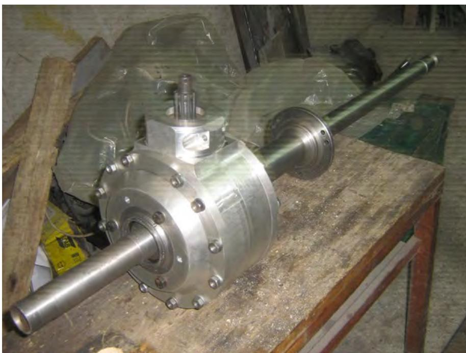
Рис. № 3.7.2. Редуктор соосного вертолётá.
