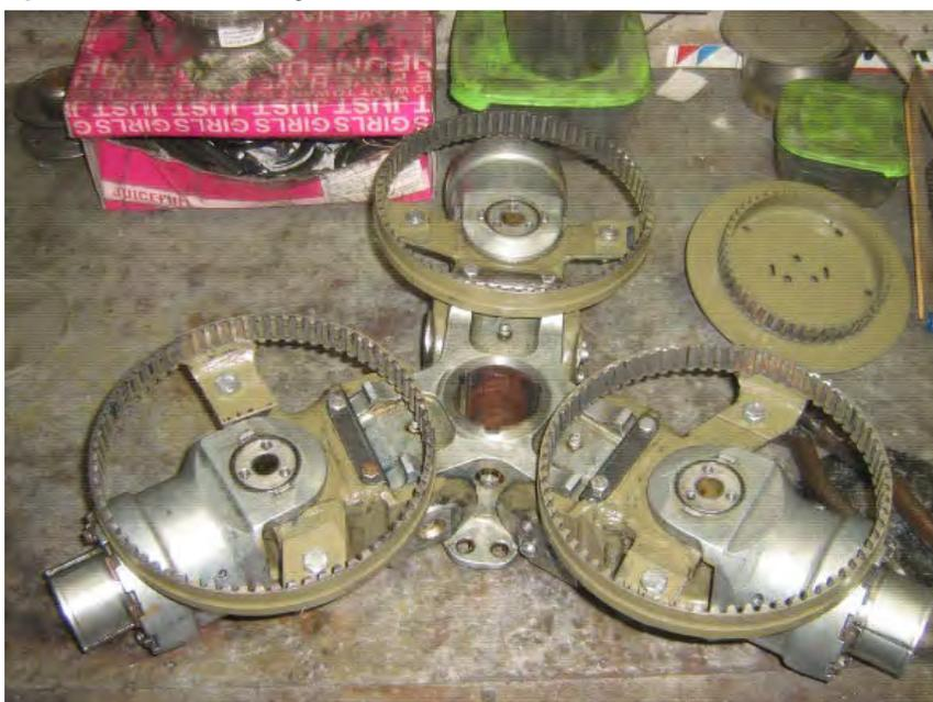
Рис. № 3.10.5. Обоймы демпферов горизонтальных шарниров.
