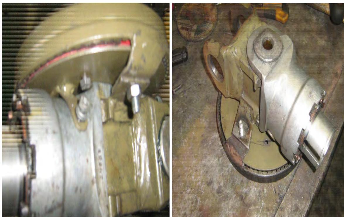
Рис. № 3.10.9. Места креплений двух обойм фрикционного демпфера.
