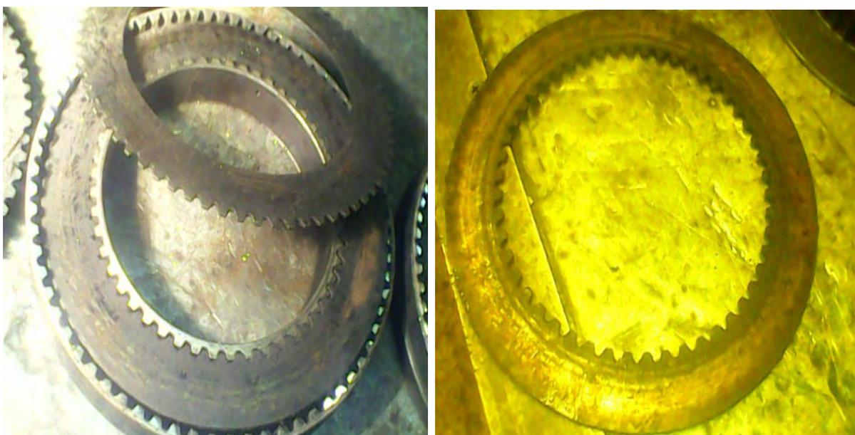
Рис. № 3.10.1. Основа демпферов - тормозная муфта редуктора вертолёта МИ-2.
