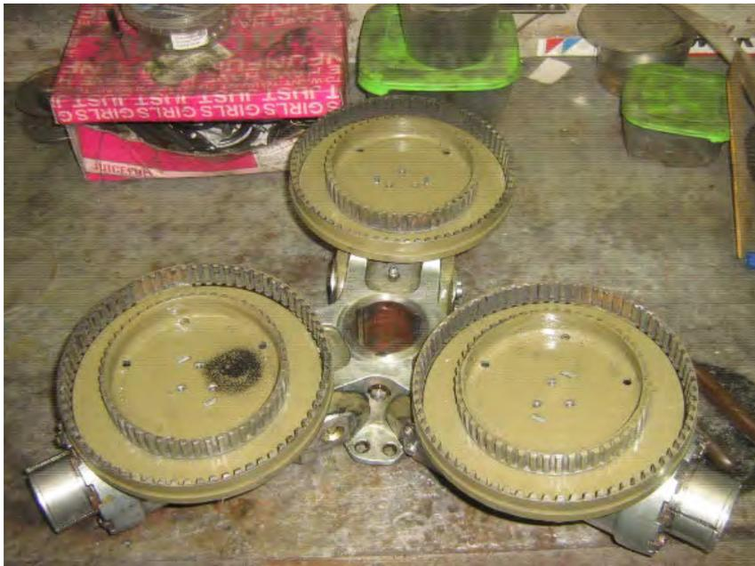
Рис. № 3.10.4. Обоймы фрикционных демпферов.
