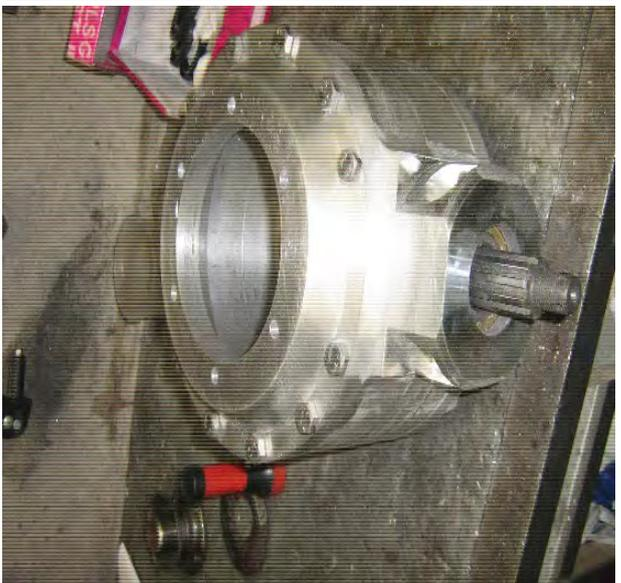
Рис. № 3.7.6. Внешний вид редуктора.
