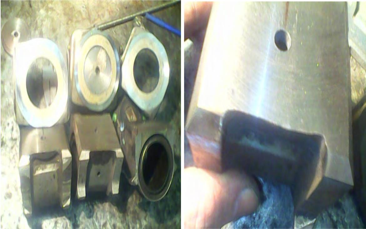
Рис. № 3.9.4. Снятие фаски и подготовка к сварке “на горячую”
