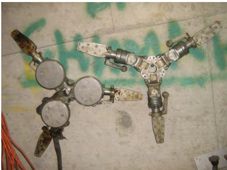
Рис. № 3.9.10. Сварные трёхлопастные втулки с горизонтальными и вертикальными шарнирами вертолётa ха-3
