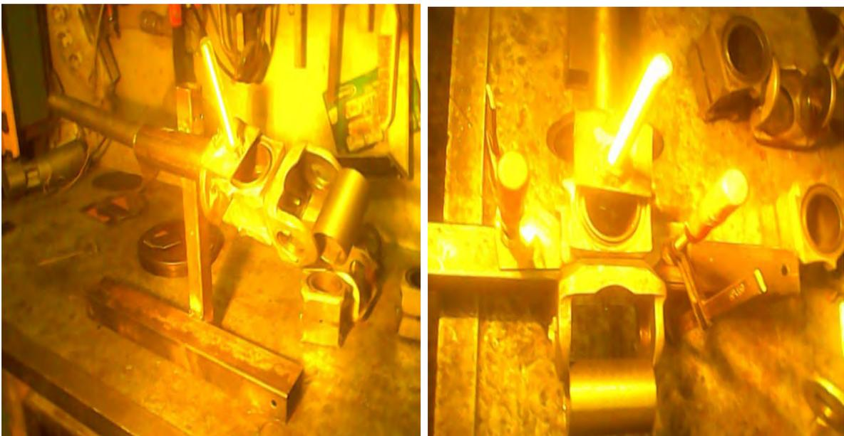
Рис. № 3.9.5. Временный стенд для сварки “на горячую”
