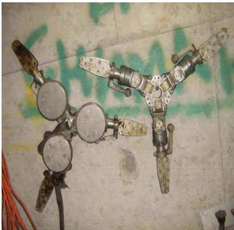
Рис. № 3.10.10. Фрикционные демпферы в сборе.
