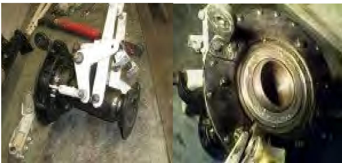
Рис. № 2.3.3. Внешний вид автомата перекоса на шарнире.
