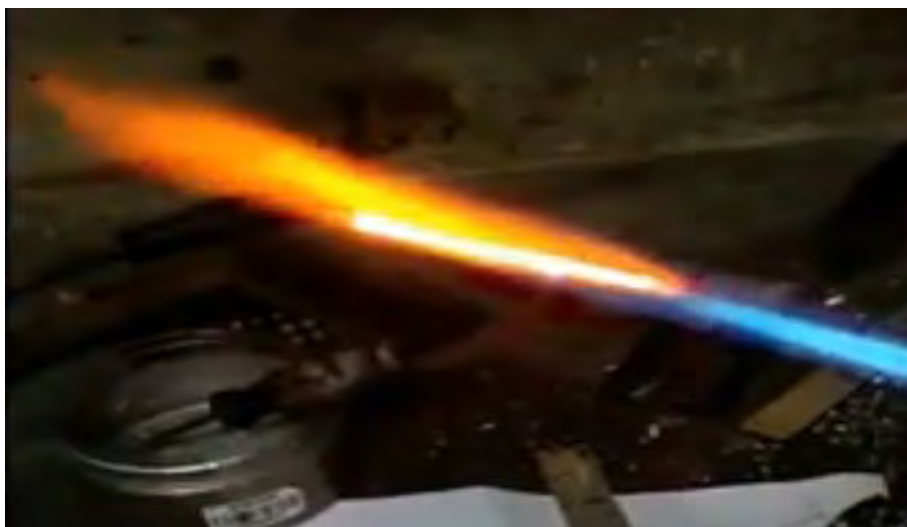
Рис. № 2.1. Само распространяющийся высокотемпературный синтез (СВС) огнестойкого защитного покрытия на стальном прутке.
