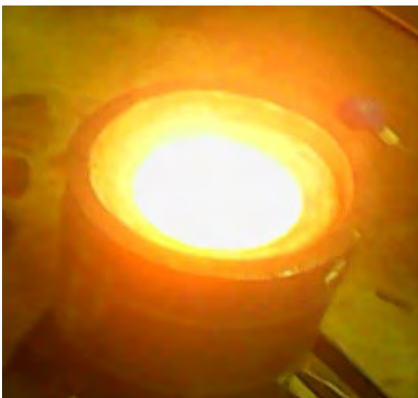
Рис. № 4.2. Само распространяющийся высокотемпературный синтез (СВС) полочек под нагревательную спираль внутри печи.
