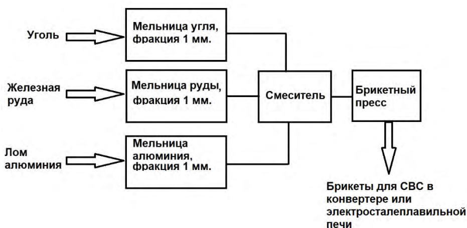
Рис. № 6.1. Технология производства брикетов для СВС карбида железа.
