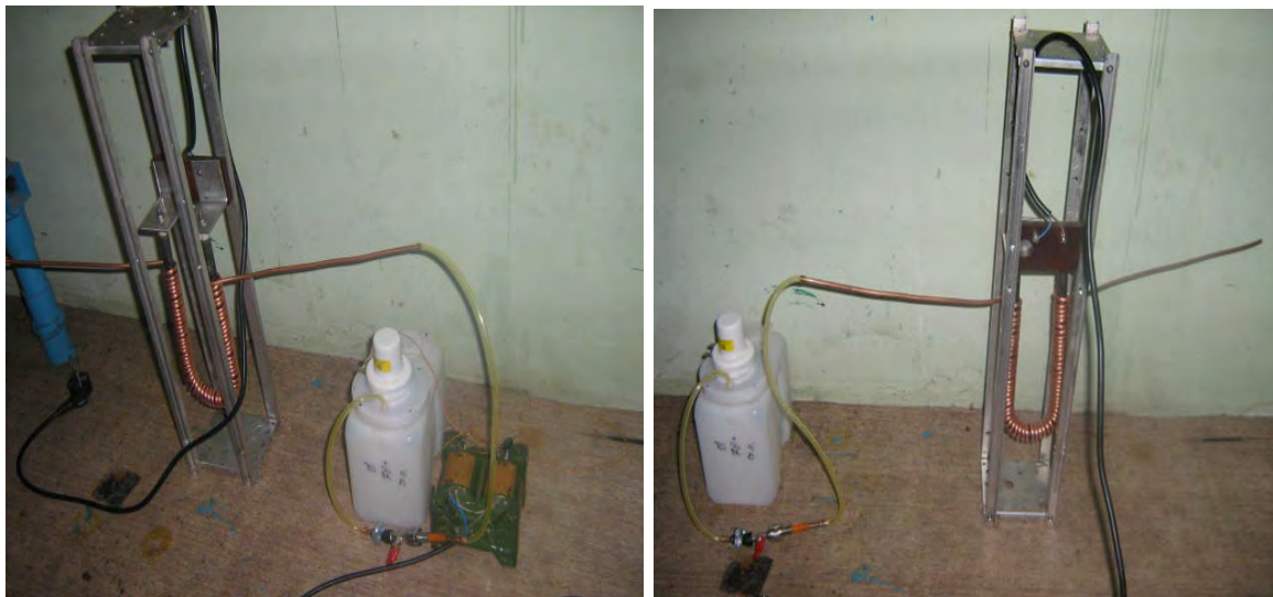
рис. № 4.1. Генератор тумана для визуализации вихревых течений
