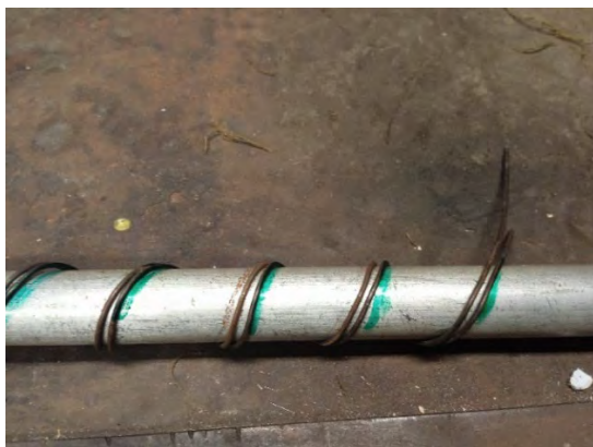
Рис. № 2. Разметка трубы и намотка спирали
