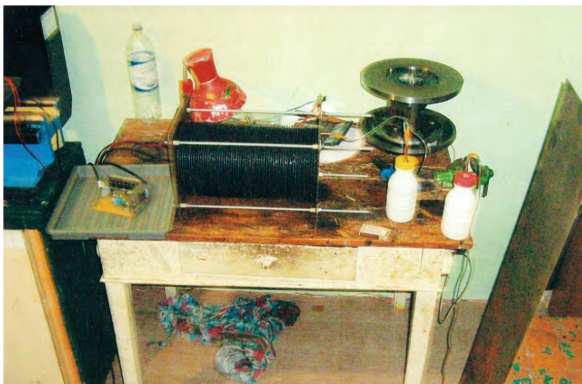
Рис. № 1.1. Электролизерная система генерации водорода.
