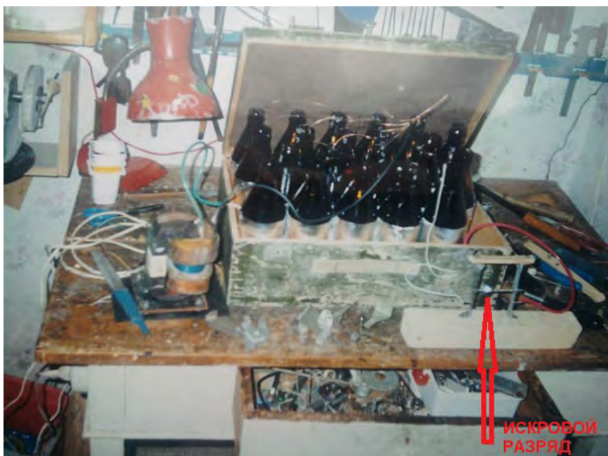
Рис. № 6.1. Блок из высоковольтных конденсаторов.
