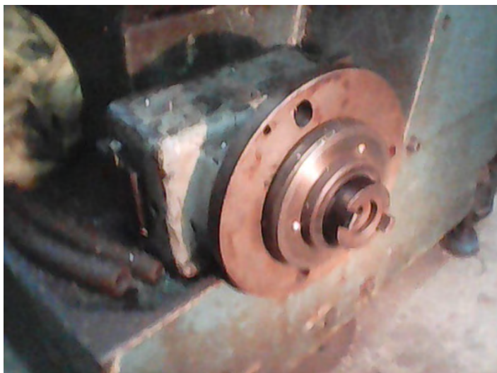
Рис. № 9.1 Крепёжный фланец долбёжной головки 676-го станка.
