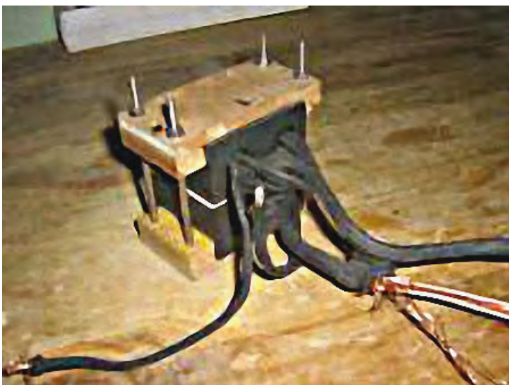
Рис. № 5.3. Высокочастотный ферритовый трансформатор.
