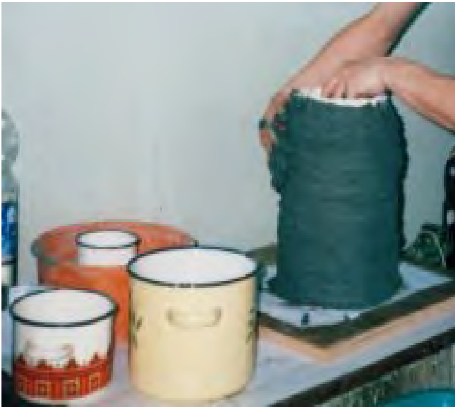
Рис. № 7.1. Изготовление муфеля печи.
