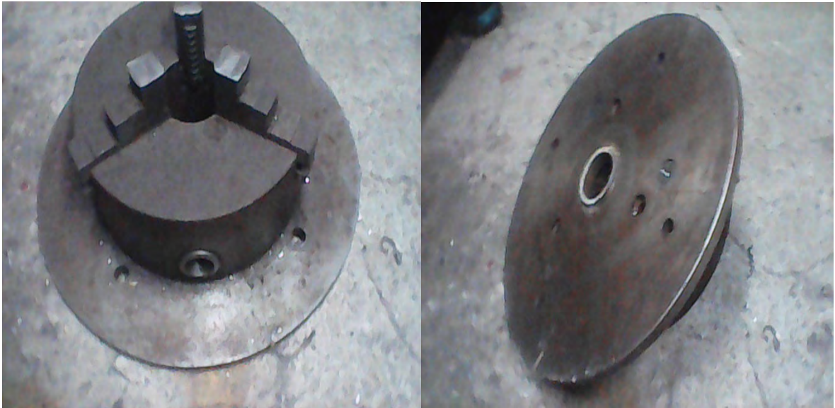
Рис. № 11.1. Внешний вид переходной план-шайбы.
