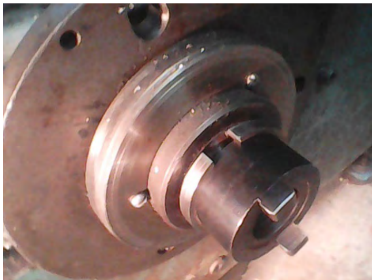
Рис. № 9.5. Переходник в сборе с долбежной головкой.
