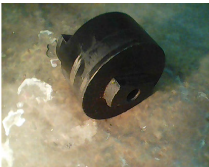
Рис. № 9.2. Привод вращения долбёжной головки 676-го станка.
