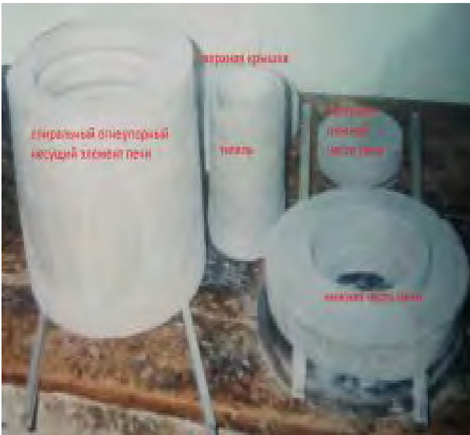
Рис. № 7.2. Элементы печи перед обжигом.
