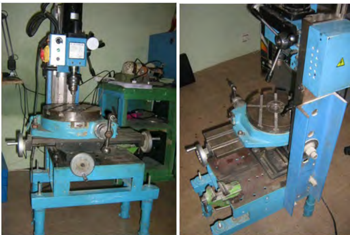
Рис. № 8.1. Внешний вид универсального сверлильно-фрезерного станка.
