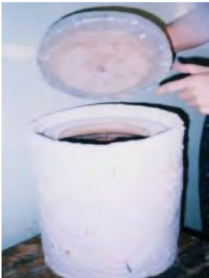
Рис. № 7.3. Огнеупорная часть печи в сборе.
