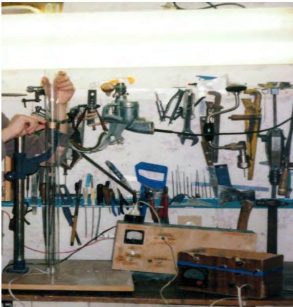
Рис. № 3.2. Тепловой автогенератор звука Рийке из стеклянной лампы дневного света.
