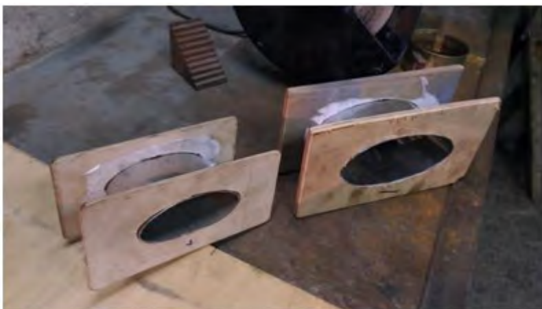
Рис. № 5. Резонаторы в виде эллиптического патрубка.
