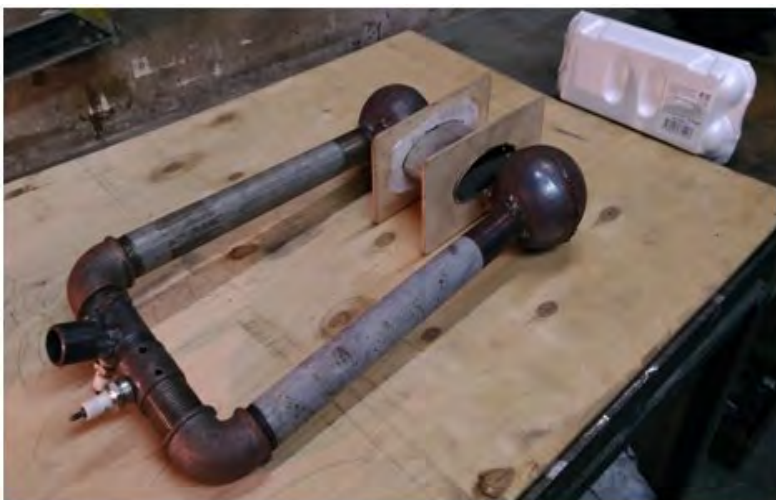
Рис. № 6. Стенд детонационного схлопывания (накачки) в резонаторе двух волн детонационного горения от двух источников.
